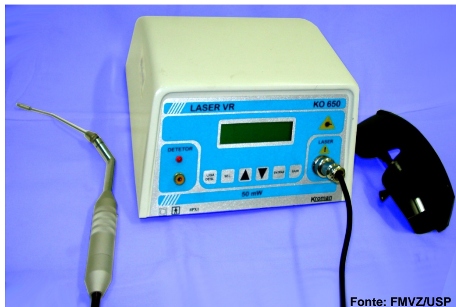
Figura 3 – Equipamento laser utilizado no experimento, modelo KO650 (Kroman, São Paulo, Brasil), acompanhado da ponteira acoplada à peça-de-mão, além do óculos de proteção, de uso obrigatório durante a irradiação da luz laser
