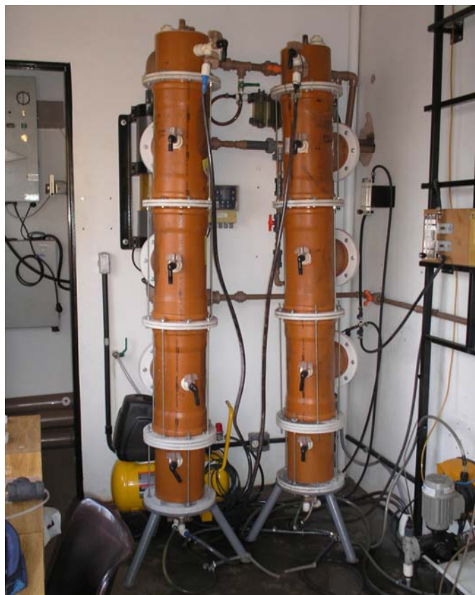
Figura 4.9: Fotografia dos biofiltros montados na sala de abrigo
