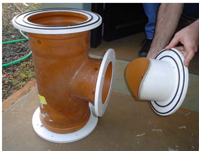
Figura 4.6: Fotografia da conexão “tê” flangeada com a janela de amostragem
