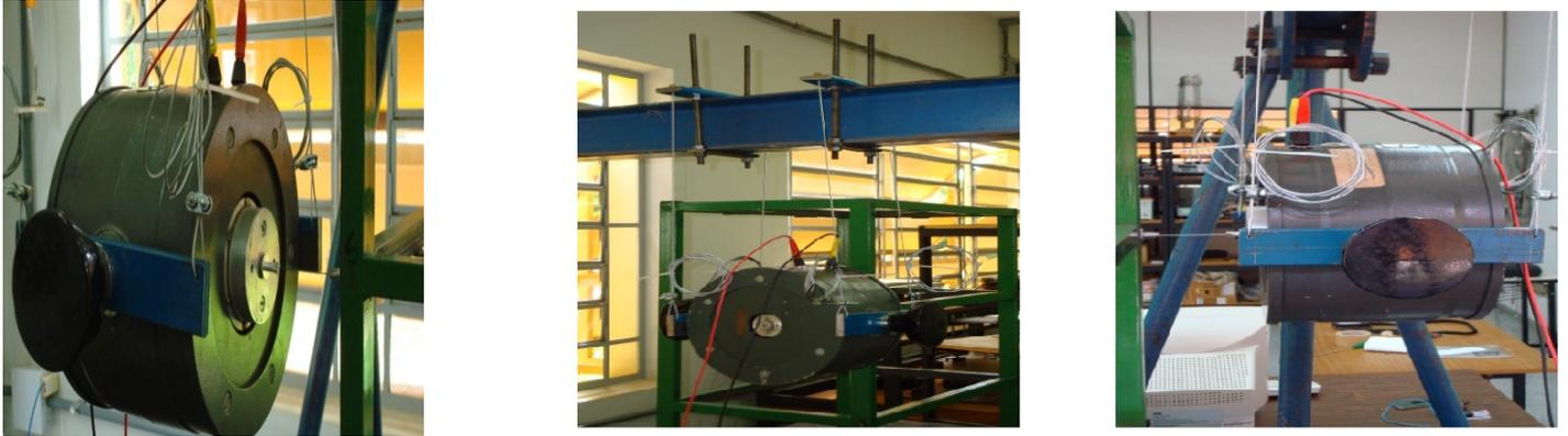
Figura 6.5 Detalhes da Excitação da Estrutura utilizando o Shaker
