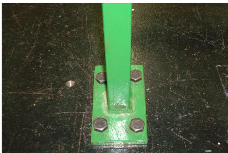
Figura 6.4 – Condição de Engaste da Estrutura
