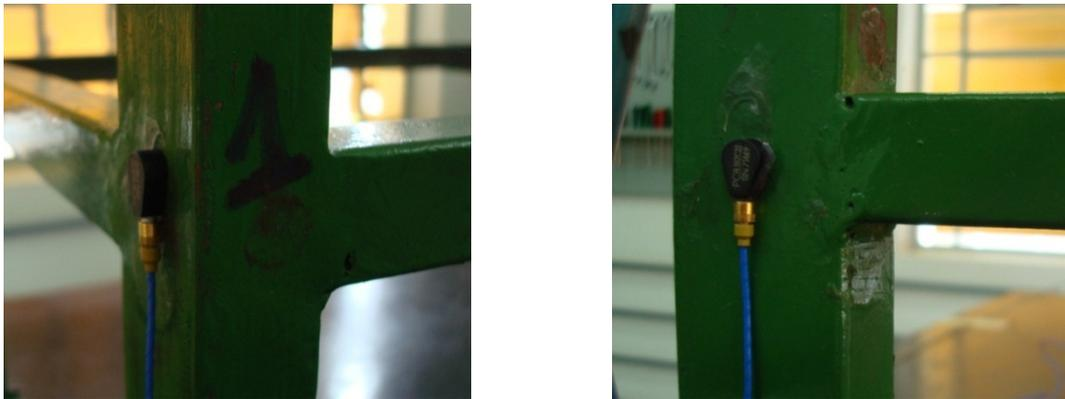
Figura 6.6 – Detalhes da Fixação do acelerômetro no Frame
