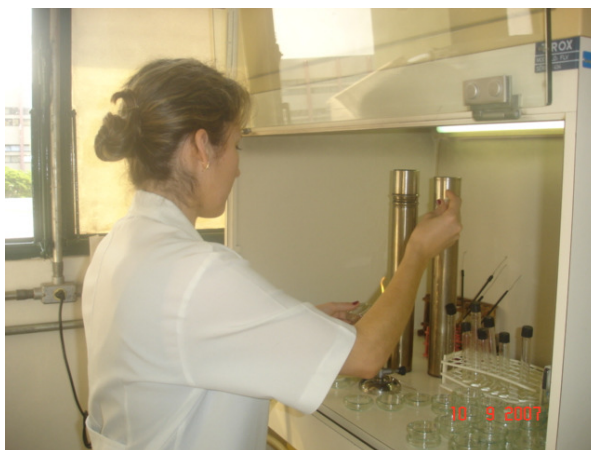
Figura 13 – Preparações das diluições e posterior inoculação do frozen em placas de Petri na câmara de fluxo laminar.
