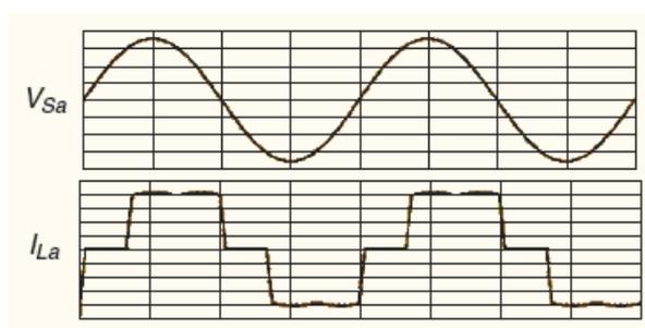
Figura 2 – Formas de onda típicas de tensão e corrente de um retificador com filtro c.c. indutivo.
