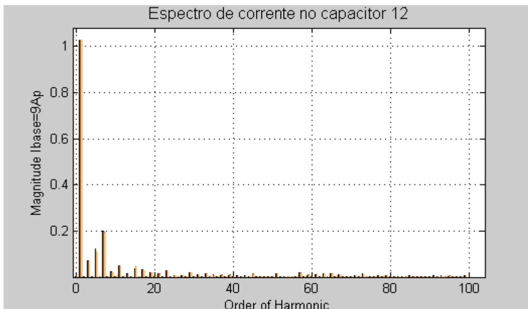
Figura 118 - Espectro da corrente no capacitor 12. Rede AT com 1% de 5h e 0,5% de 7h.
