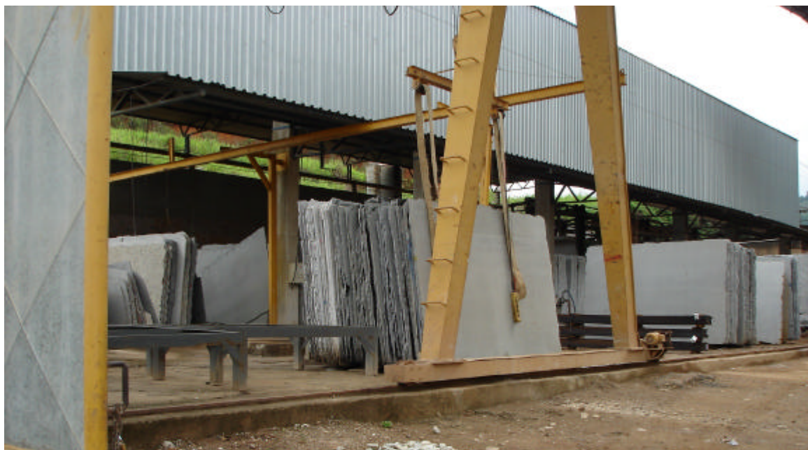
Figura 4 - Chapas de granito desdobradas através do processo de serrada de blocos em uma empresa de Cachoeiro de Itapemirim, ES, fotografada pelo autor em 04/09/2006.
