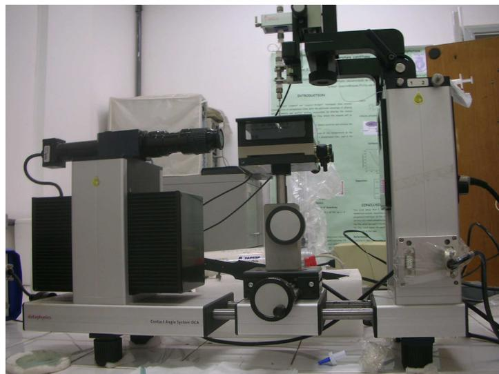
**Figura 29:** Tensiômetro de gota pendente.
