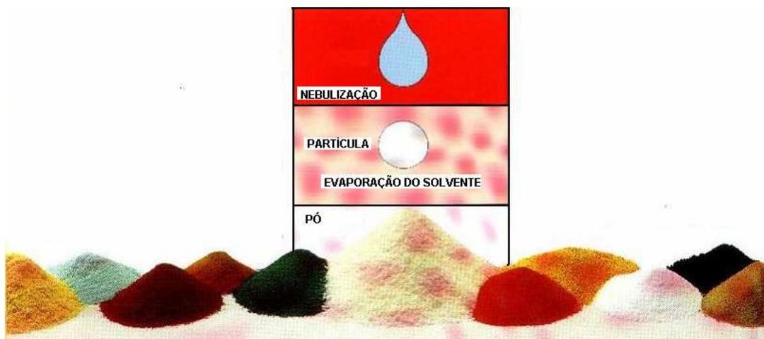
**Figura 17:** Representação ilustrativa do processo *spray drying*.
