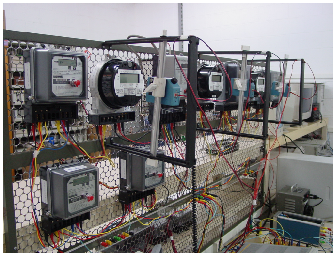
Figura 3.13 - Detalhe do “arranjo geral de ensaio” para os medidores de energia eletrônicos, utilização de foto-célula.
