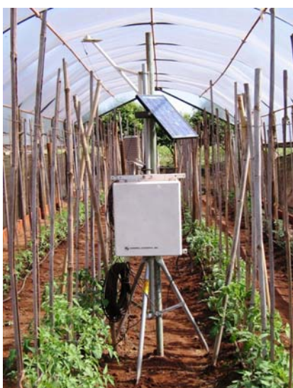
Figura 3. Vista da estação climatológica automática utilizada no experimento em abrigo protegido. Ilha Solteira (SP), 2007.
