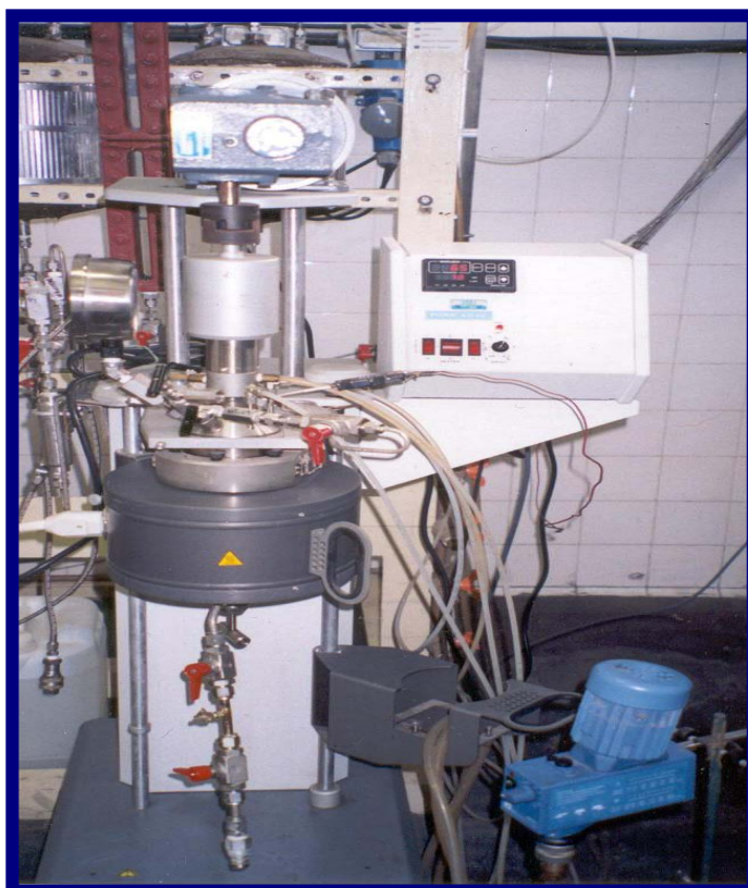
Figura 26: Vista frontal do reator de polimerização
