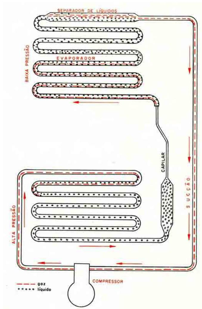
Figura 1 - Ciclo de refrigeração de um refrigerador [14]
