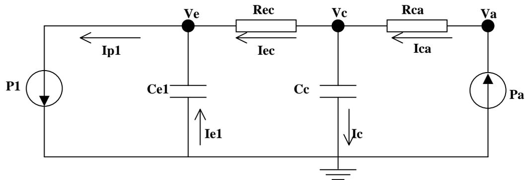
Figura 2 – Circuito elétrico do tipo RC com fonte de corrente parcial P1
