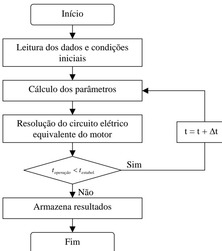
Figura 6 – Diagrama de blocos do aplicativo para simulação do desempenho do motor de indução
