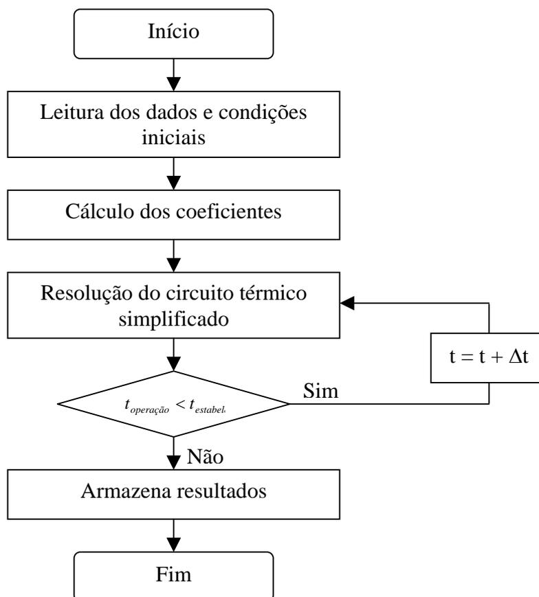
Figura 5 – Diagrama de blocos do aplicativo para simulação do comportamento térmico
