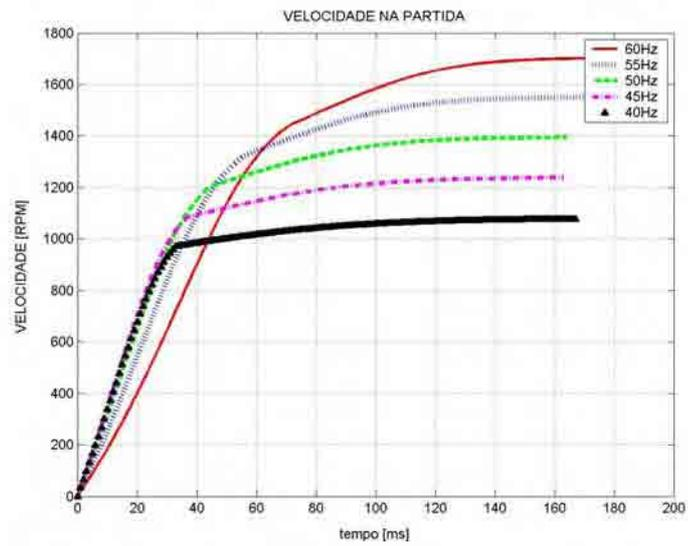
Figura 46 – Velocidade do motor de indução na partida
