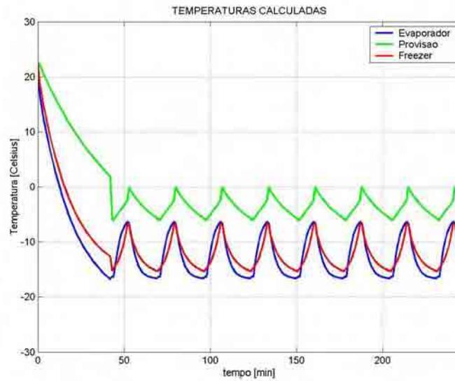
Figuras 30 – Curvas das temperaturas de ensaio na parede do evaporador, do ar no congelador e do ar no gabinete de refrigeração no sistema ON-OFF
