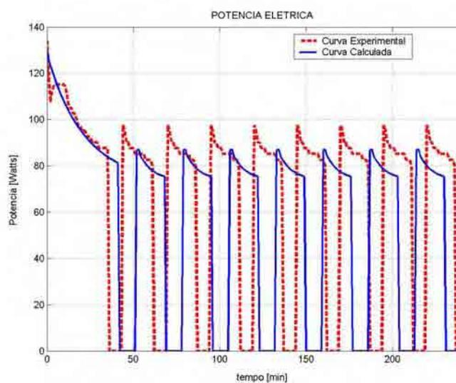
Figuras 29 – Curvas das temperaturas de ensaio e calculada da potência elétrica ativa de entrada no sistema ON-OFF
