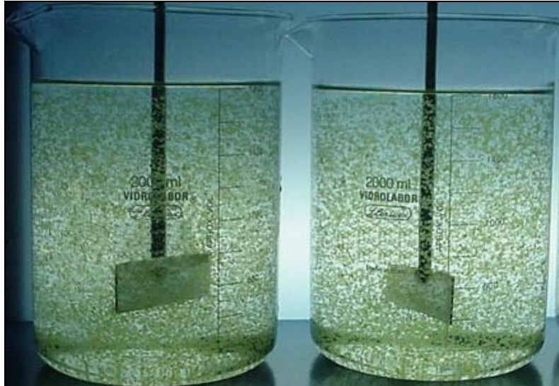
Figura 4.5: Teste de jarros sendo aplicado nas amostras em duplicata do Reservatório São Paulo (R1), pertencente ao Complexo Dal Bó, Caxias do Sul – RS.
