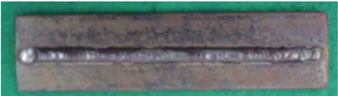
Figura 17 – Solda realizada utilizando o grupo 6 – A_p = 420A ; A_b = 30A ; F = 100 Hz e T_p = 2,00 ms.
