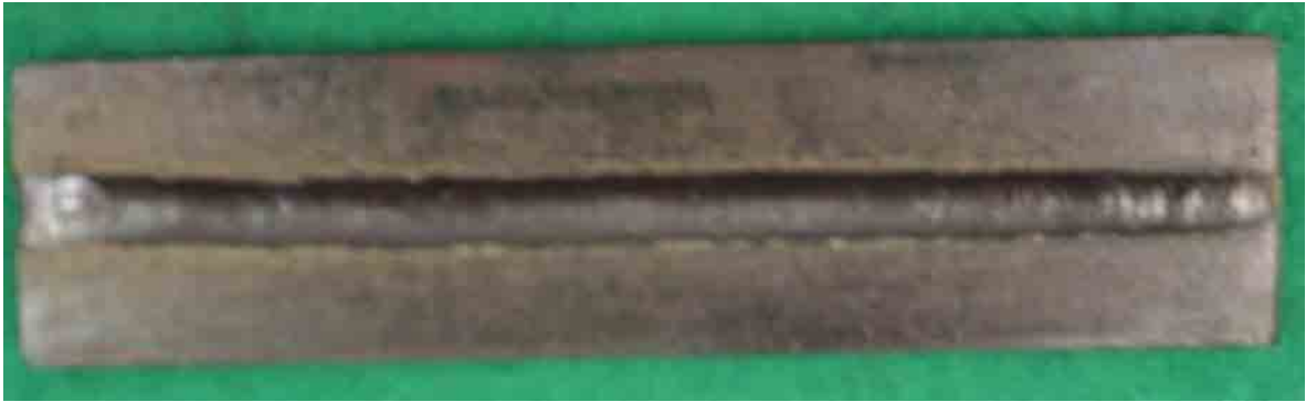
Figura 25 – Solda realizada utilizando o grupo 14 – A_p = 350A ; A_b = 30A ; F = 150 Hz e T_p = 2,20 ms.
