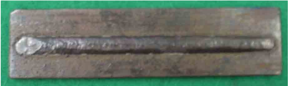
Figura 19 – Solda realizada utilizando o grupo 8 – A_p = 400A ; A_b = 40A ; F = 100 Hz e T_p = 2,00 ms.
