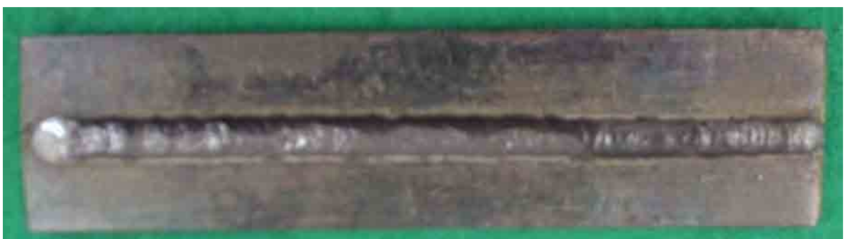
Figura 24 – Solda realizada utilizando o grupo 13 – A_p = 350A ; A_b = 30A ; F = 100 \text{ Hz} e T_p = 2,50 \text{ ms} .
