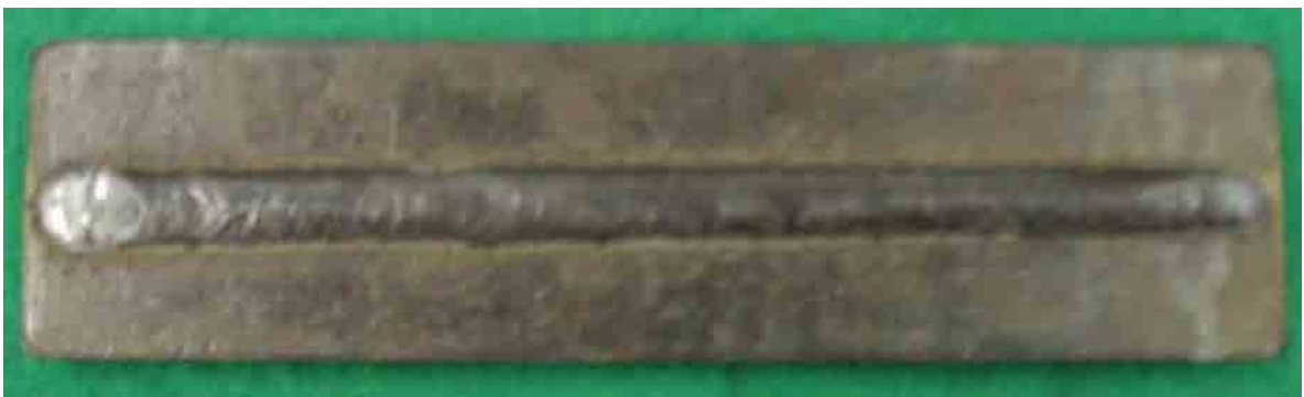
Figura 21 – Solda realizada utilizando o grupo 10 – A_p = 350A ; A_b = 30A ; F = 100 Hz e T_p = 2,20 ms.
