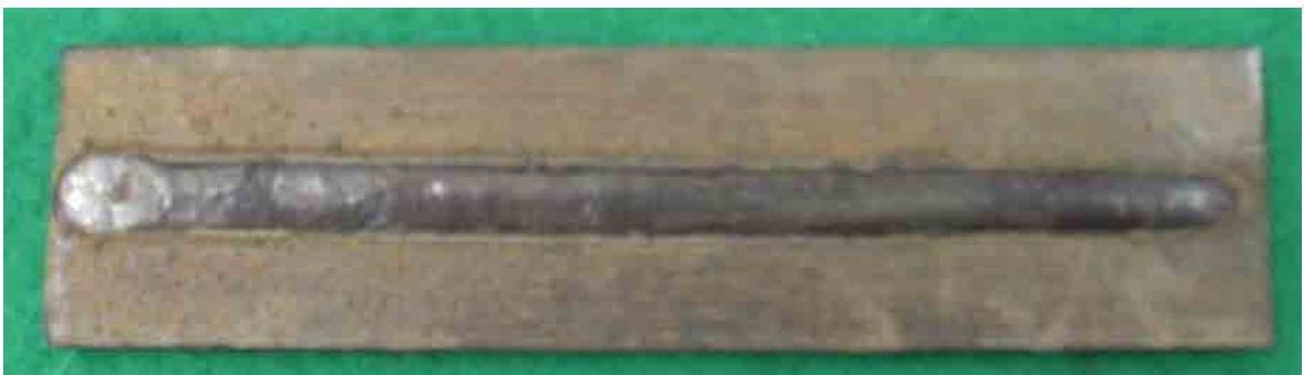
Figura 12 – Solda realizada utilizando o grupo 1 – A_p = 350A ; A_b = 30A ; F = 100 Hz e T_p = 2,00 ms.
