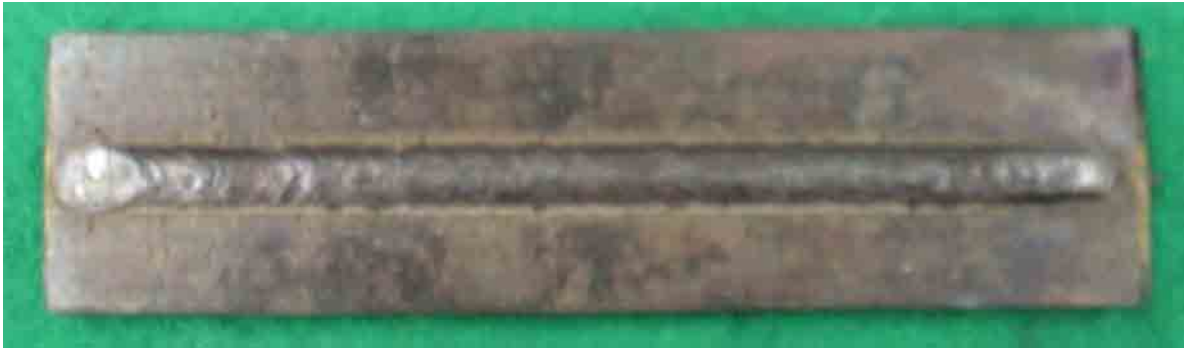
Figura 22 – Solda realizada utilizando o grupo 11 – A_p = 350A ; A_b = 30A ; F = 125 \text{ Hz} e T_p = 2,20 \text{ ms} .
