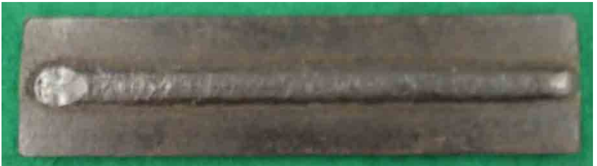
Figura 23 – Solda realizada utilizando o grupo 12 – A_p = 420A ; A_b = 50A ; F = 125 \text{ Hz} e T_p = 2,20 \text{ ms} .
