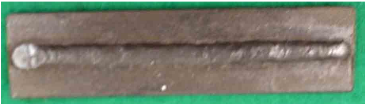
Figura 15 – Solda realizada utilizando o grupo 4 – A_p = 420A ; A_b = 50A ; F = 100 Hz e T_p = 2,00 ms.
