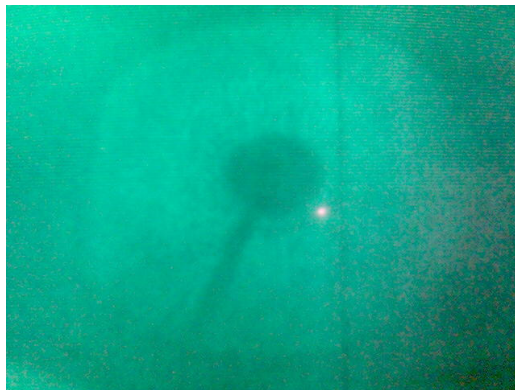
FIG. 3.35 Imagem do feixe na posição do receptor, obtida por uma câmera de vídeo.
