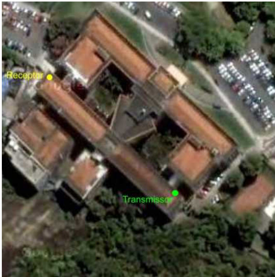
FIG. 3.48 Posições do transmissor e do receptor FSO no enlace de 93 m montado no telhado do IME
