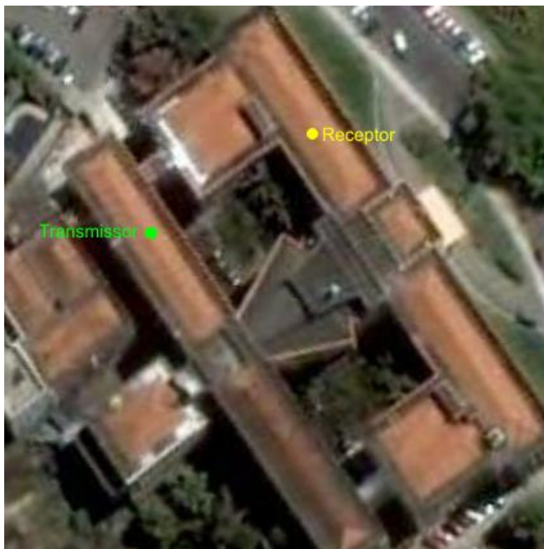
FIG. 3.42 Posições do transmissor e do receptor FSO no enlace de 39 m montado no IME
