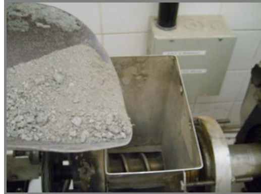
(b) Sistema de alimentação do forno
