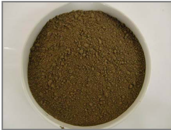
Figura 4.28: Aspecto e granulometria da CVRSU após moagem.
