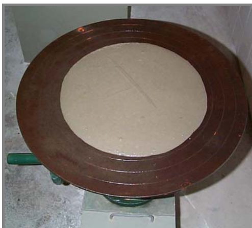
Figura 5.12: Ensaio de espalhamento na mesa de consistência padrão.
