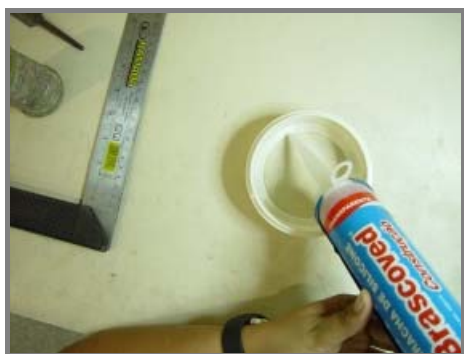
(b) Colocação de silicone na parte inferior do CAP para vedação da amostra.
