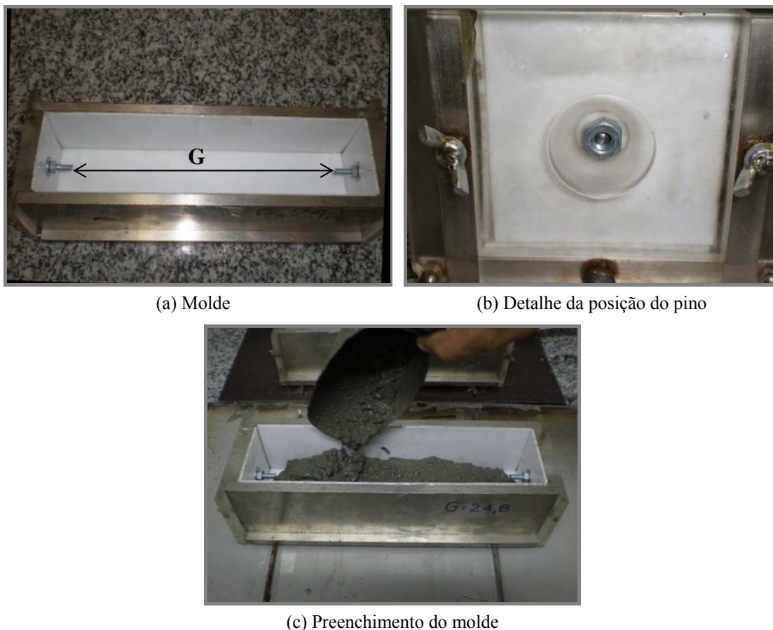
Figura 5.14: Preparação e moldagem do prisma.
