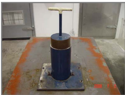
(c) colocação do pistão sobre o cilindro – vibração e compactação
