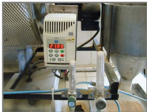
(c) Controlador da velocidade de rotação do forno
