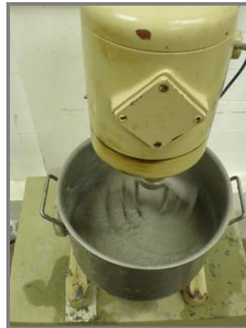
(b) homogeneização do cimento com a areia
