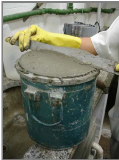
(c) Rasamento e limpeza do molde
