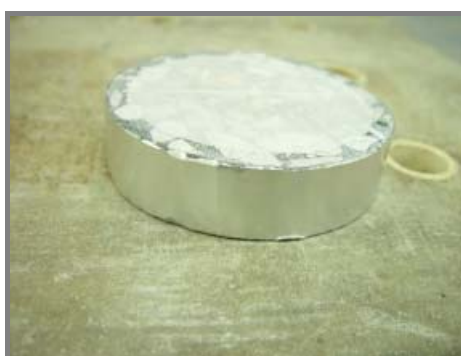
(a) Vedação da face curva com fita alumínio.
