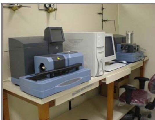
Figura 4.11: Equipamento de análise térmica diferencial e termogravimétrica com DSC.
