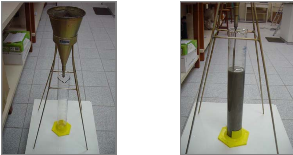
Figura 5.2: Ensaio de compatibilidade: (a) cone de marsh + proveta e (b) medição do tempo de escoamento.
