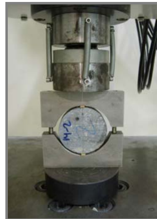
(b) Ensaio em amostra com 100mm de diâmetro
