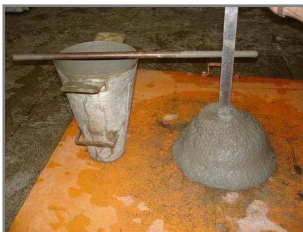
Figura 5.10: Ensaio de abatimento realizado na mistura CR60.
