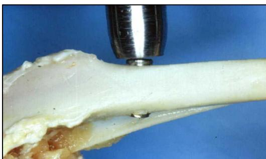
Figura 4.26 - Aspecto da tíbia direita do coelho nº 2 já posicionada para o ensaio
