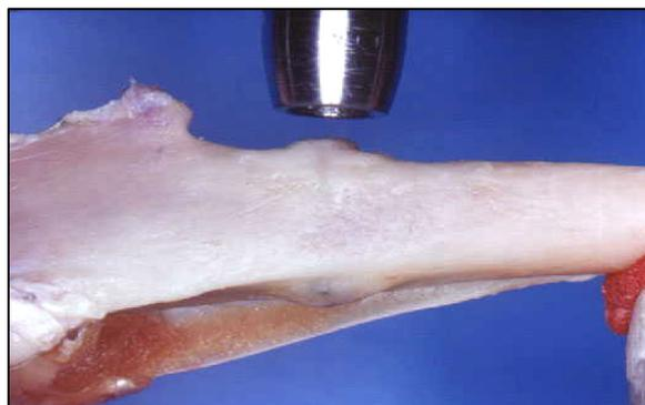
Figura 4.22 - Tíbia direita, com implante osseointegrado, do coelho nº 17, antes de seu ensaio
