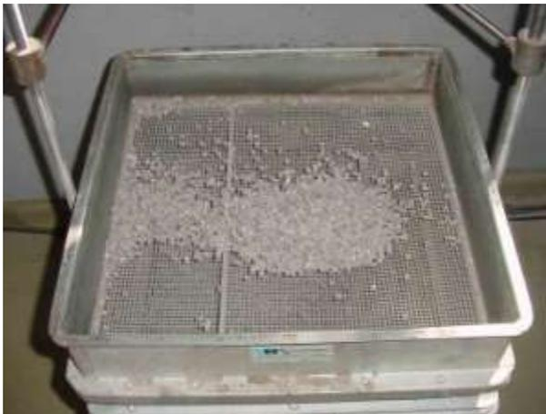
**Figura 38** - Material retido em malha 2,4 mm
