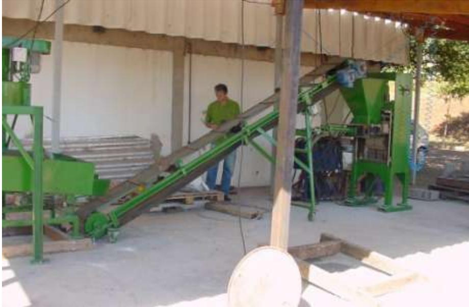
**Figura 44** - Equipamentos para fabricação de tijolos de solo-cimento
