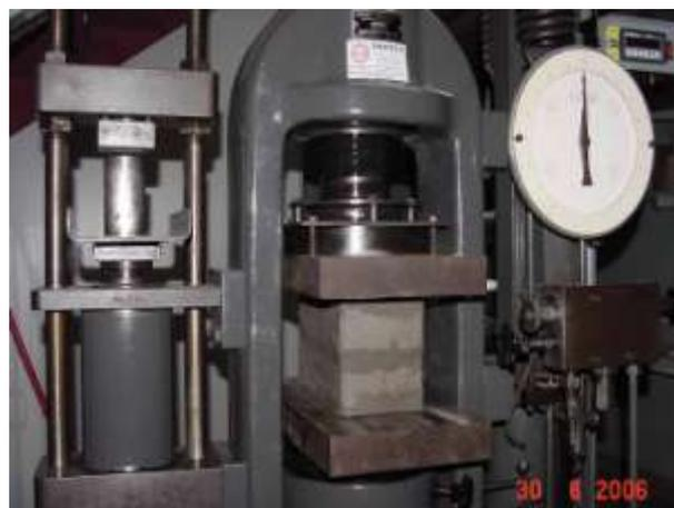
**Figura 56** - Teste de Resistência à Compressão com Blocos Superpostos
