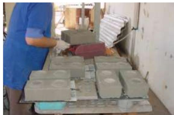
**Figura 68** - Blocos colocados em palet
