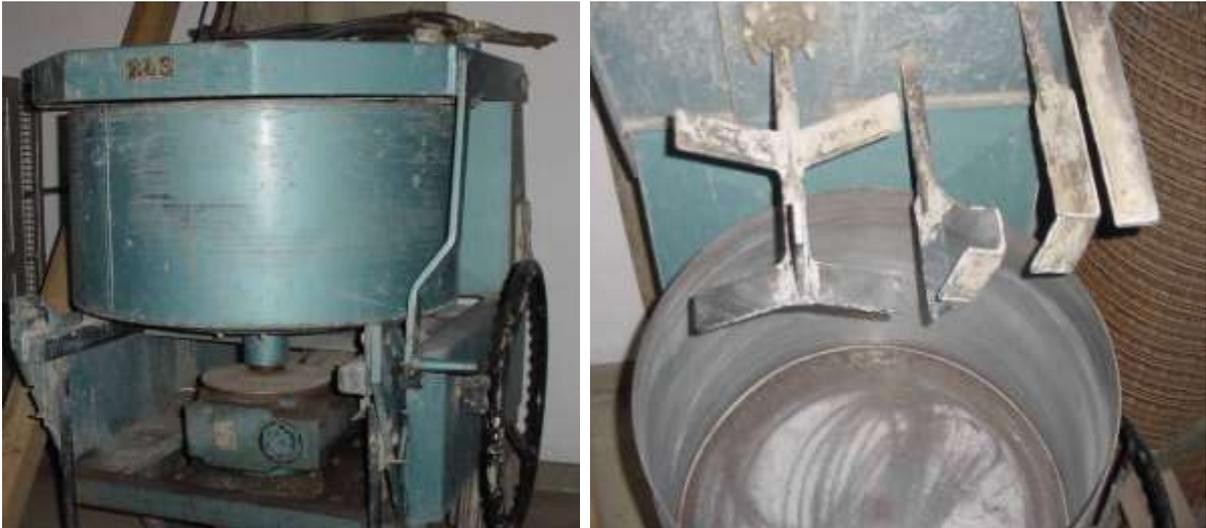
**Figura 47 e 48** - Misturador de eixo vertical (próprio para mistura de “materiais secos”)
