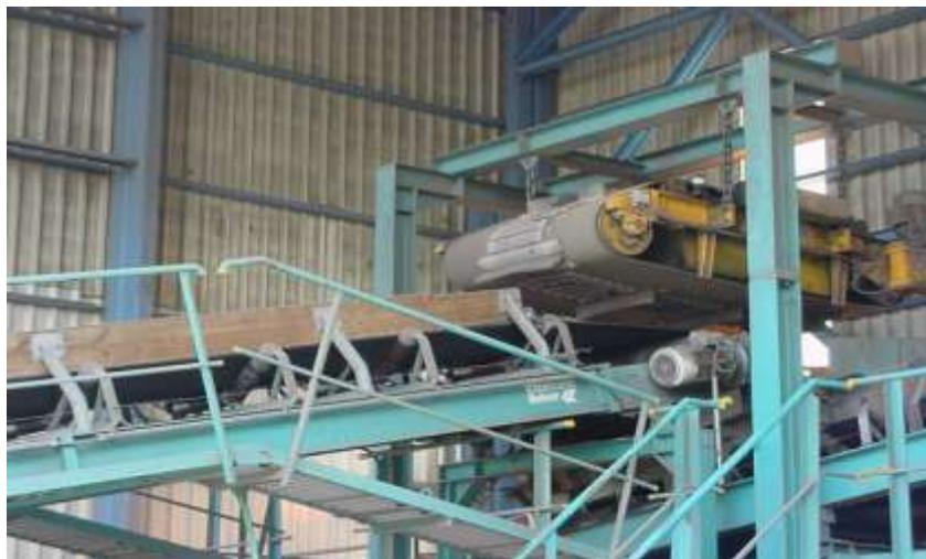
**Figura 20** - Separação Magnética (Remoção do ferro metálico)
