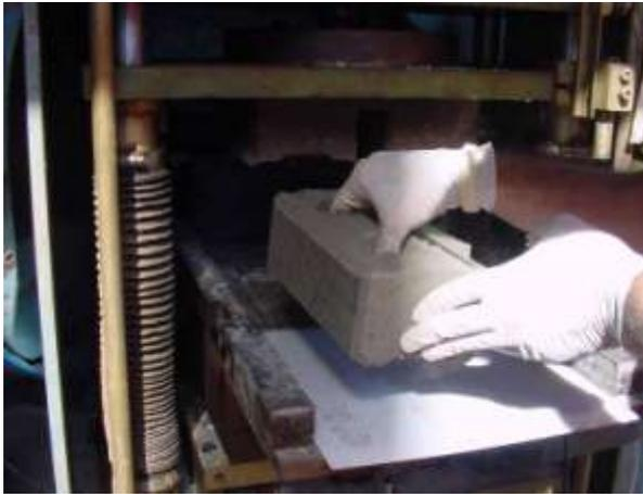
**Figura 53** - Bloco sendo retirado da prensa
