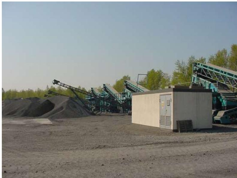
**Figura 21** - Classificação granulométrica conforme requisitos do mercado
