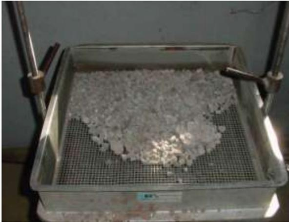
**Figura 36** - Material retido em malha 9,5 mm
