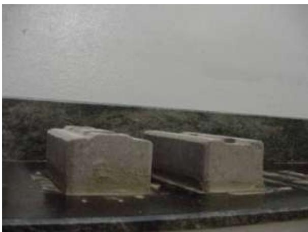
**Figura 55** - Regularização da Superfície dos Blocos com pasta de cimento
