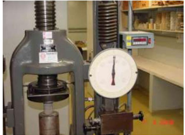
**Figura 41** - Teste de Resistência à Compressão
