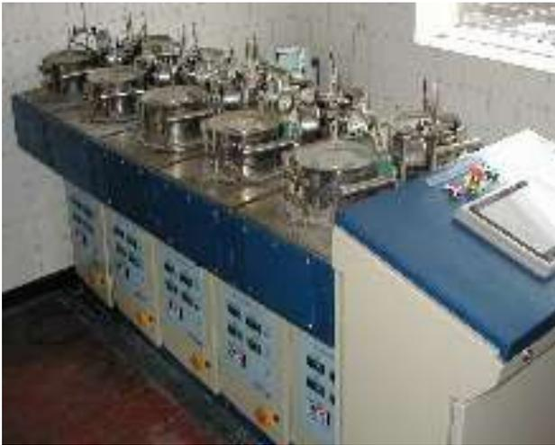
**Figura 24** - Controle de qualidade (teste de expansão)
