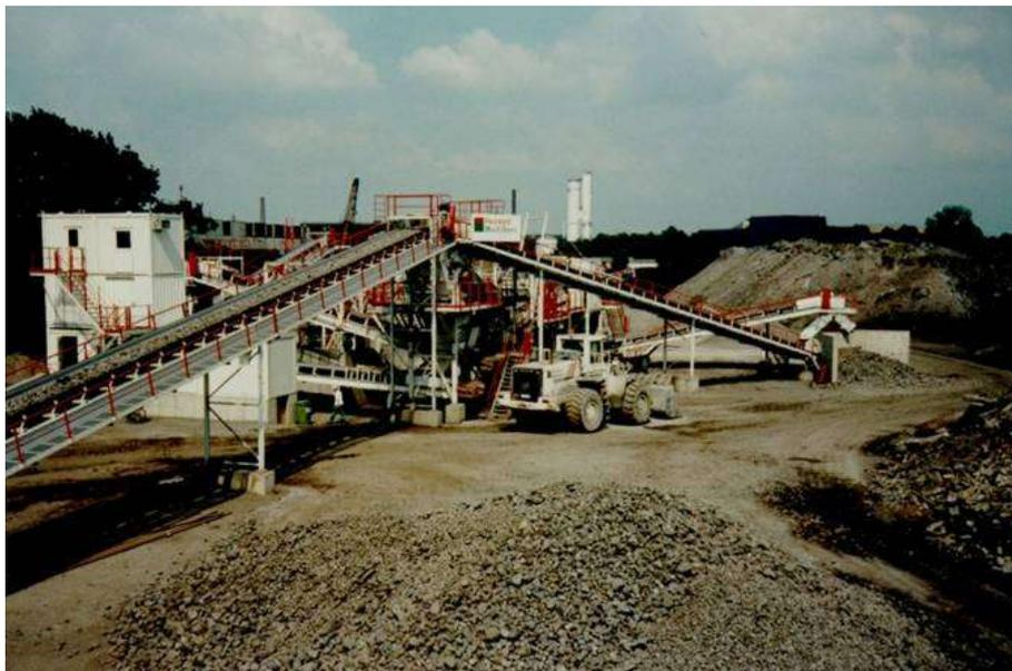
**Figura 18** - Planta e processamento da escória de aciaria
