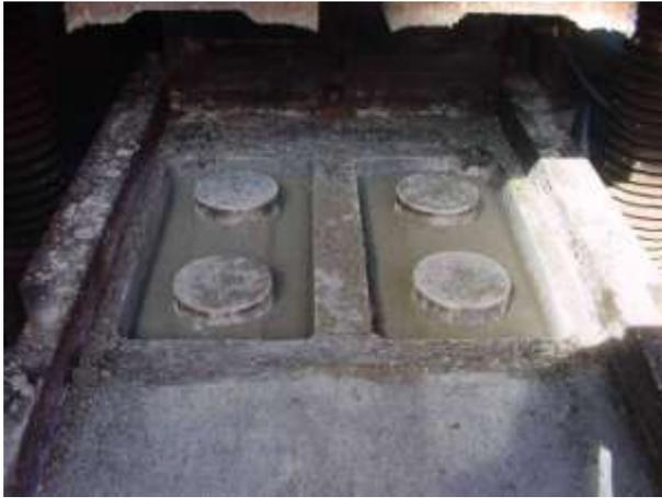
**Figura 51** - Compactação do composto pela prensa
