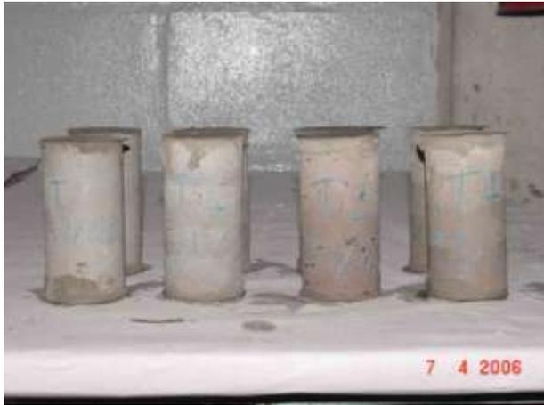
**Figura 40** - Corpos de prova de T1, T2, T3 e T4
