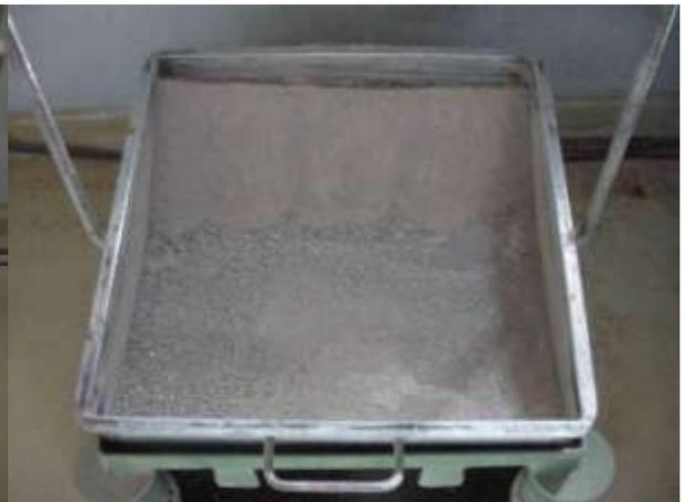
**Figura 39** - Material passante em malha 2,4 mm
