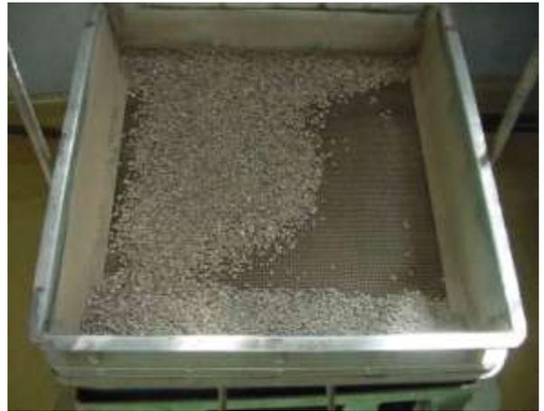
**Figura 37** - Material retido em malha 4,8 mm
