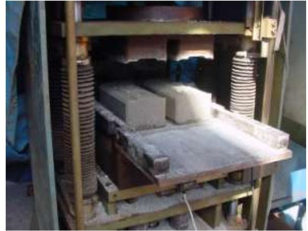
**Figura 52** - Bloco pronto para ser retirado
