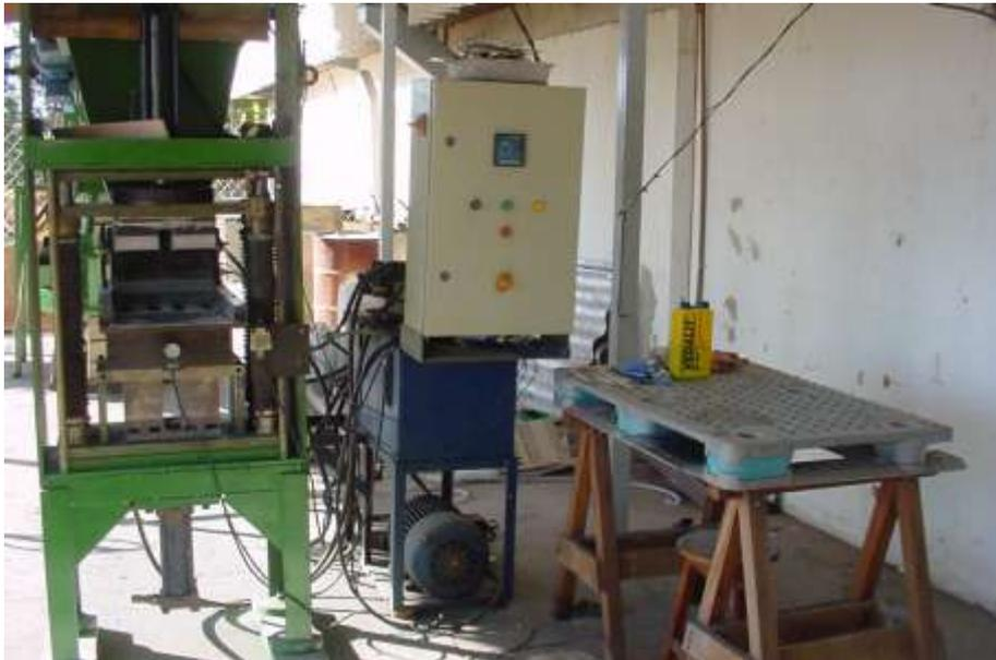
**Figura 43** - Prensa Hidráulica para fabricação de Tijolos de solo-cimento
