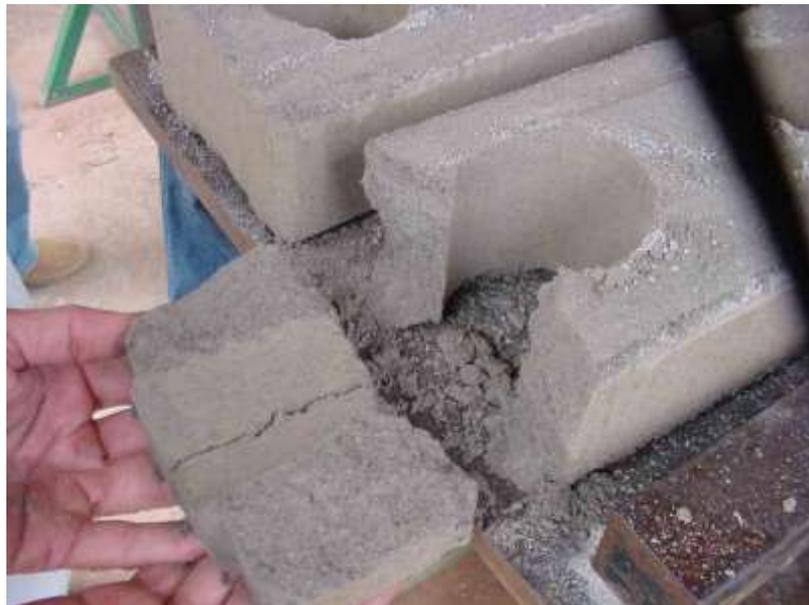
**Figura 45** - Bloco “quebradiço” logo após a prensagem (testes iniciais para avaliação do processo de moldagem)
