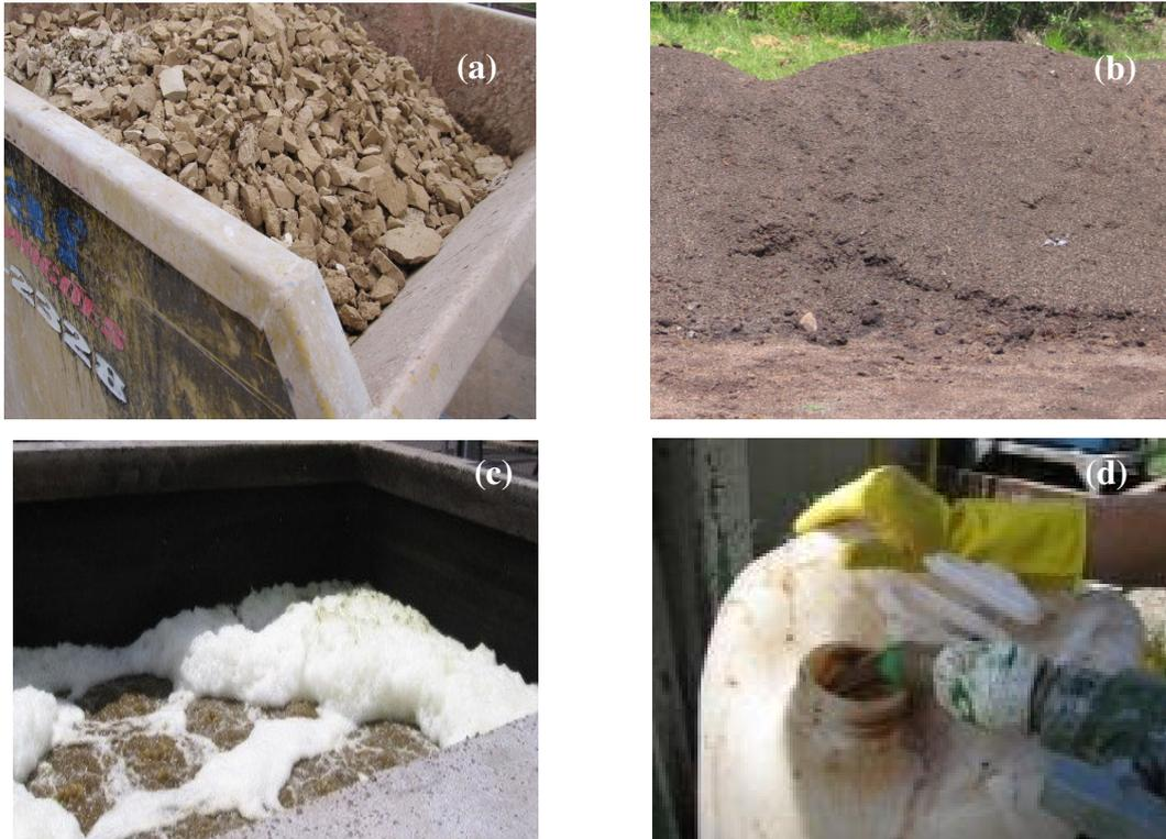
**Figura 2** - Aspecto visual do material usado na composição das pilhas (a) lodo físico-químico, (b) material orgânico, (c) e (d) lodo biológico.
