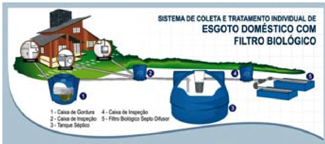
Figura 05 – Esquema de funcionamento de um sistema de tratamento de resíduos (IDHEA, 2004).
