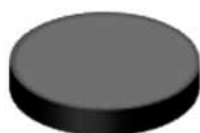
Figura 27 - Modelo de corpo de prova de absorção de água (tamanho real)
