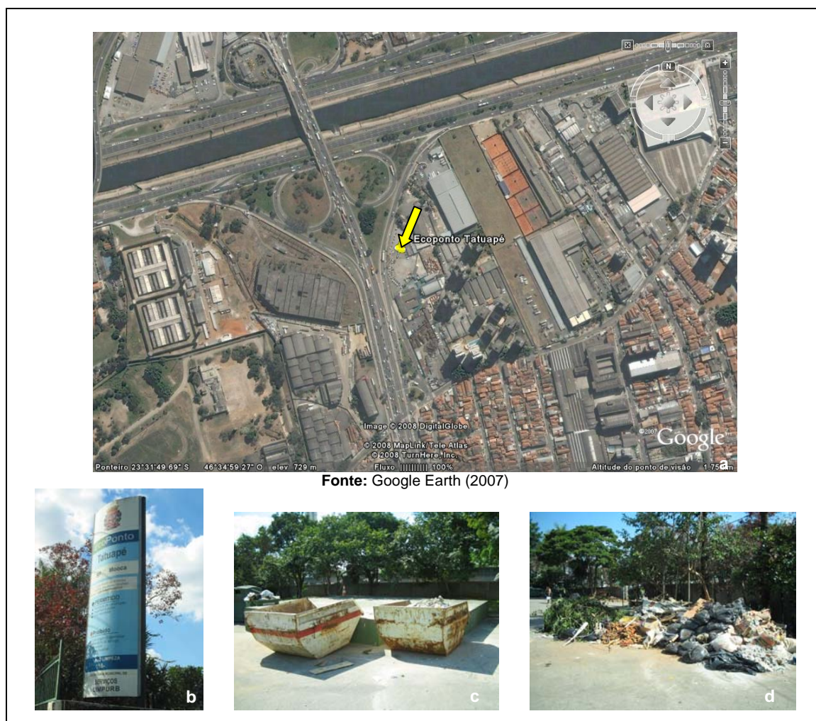
Figura 24 – Ecoponto Tatuapé: a) foto aérea da localização; b) totem; c) caçambas para o recebimento do entulho; d) entulho jogado no chão: ecoponto sem baias
