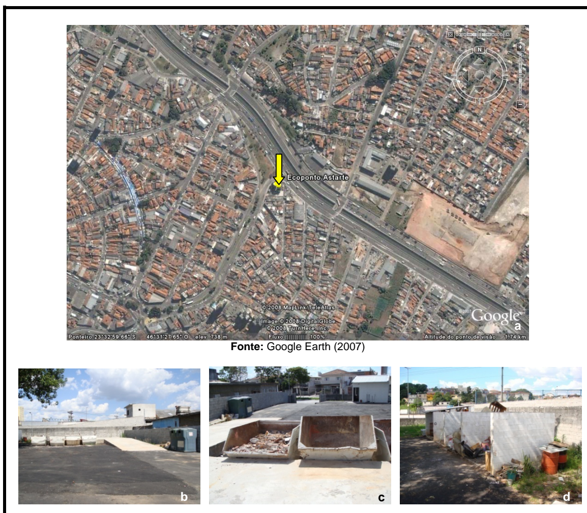
Figura 38 – Ecoponto Astarte: a) foto aérea da localização; b) entrada da unidade; c) caçambas para recebimento dos entulhos; d) baias para recebimento de inservíveis
