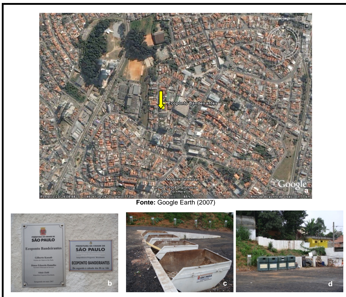
Figura 36 – Ecoponto Bandeirantes: a) Foto aérea da localização; b) placa inaugural da unidade; c) caçambas para recebimento de entulhos; d) contêineres e baias para o recebimento de inservíveis
