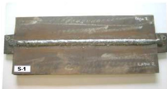
Figura 5.1 – Apresentação de uma peça após soldagem.
