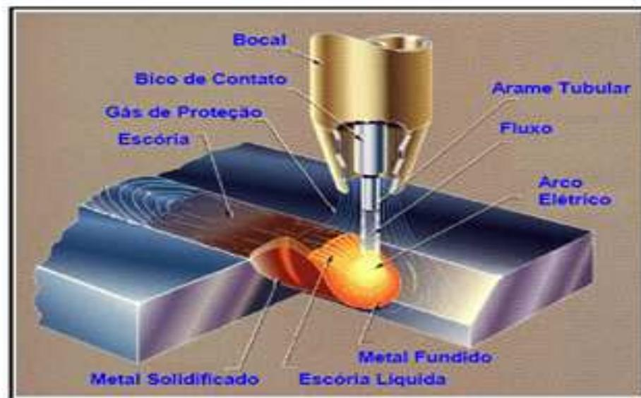
Figura 3.3 – Esquema do processo Arame Tubular com Proteção Gasosa (WELDING HANDBOOK, 1991).
