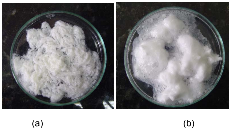
Figura 37: Precipitado formado após adição de CTAB ao fluido (a) APX 11,4 e (b) APP11,4
