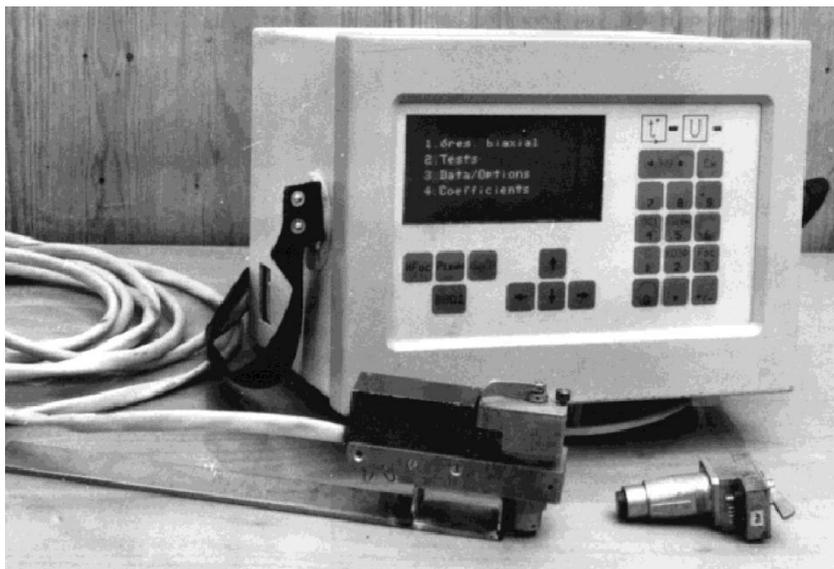
Figura 23. Conjunto ultra-sônico e transdutores para medição de tensões residuais em uma junta soldada de trilhos de trem (KUDRYAVTSEV; KLEIMAN; GUSTCHA, 2000).
