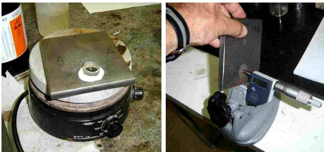
Figura 34. Remoção de camadas por ataque químico para a análise por difração de raios-X.
