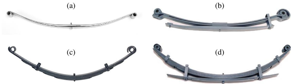
Figura 3. Molas planas: (a) Parabólica, (b) Feixe de molas parabólicas progressivo, (c) Feixe de molas trapezoidal, (d) Feixe de molas trapezoidal progressivo (ELO, 2008).
