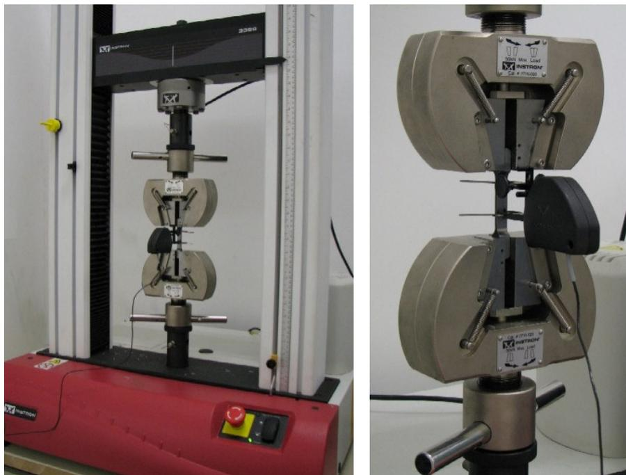
Figura 27. Ensaio de tração do aço ABNT 5160 e detalhe do extensômetro.
