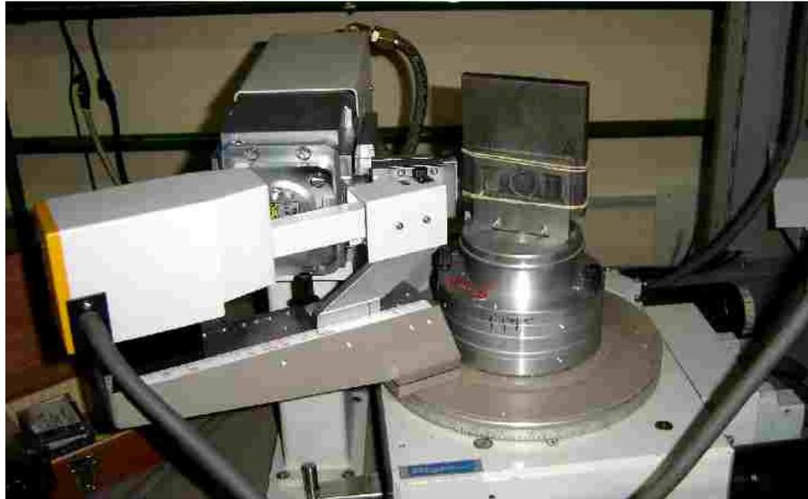
Figura 35. Montagem da amostra na máquina de difração por raios-X.
