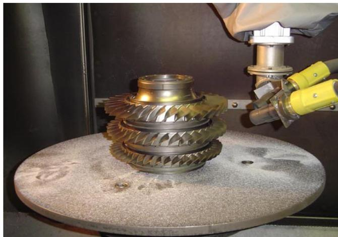
Figura 5. Aplicação do JCG em uma engrenagem (WHEELABRATOR GROUP, 2007).
