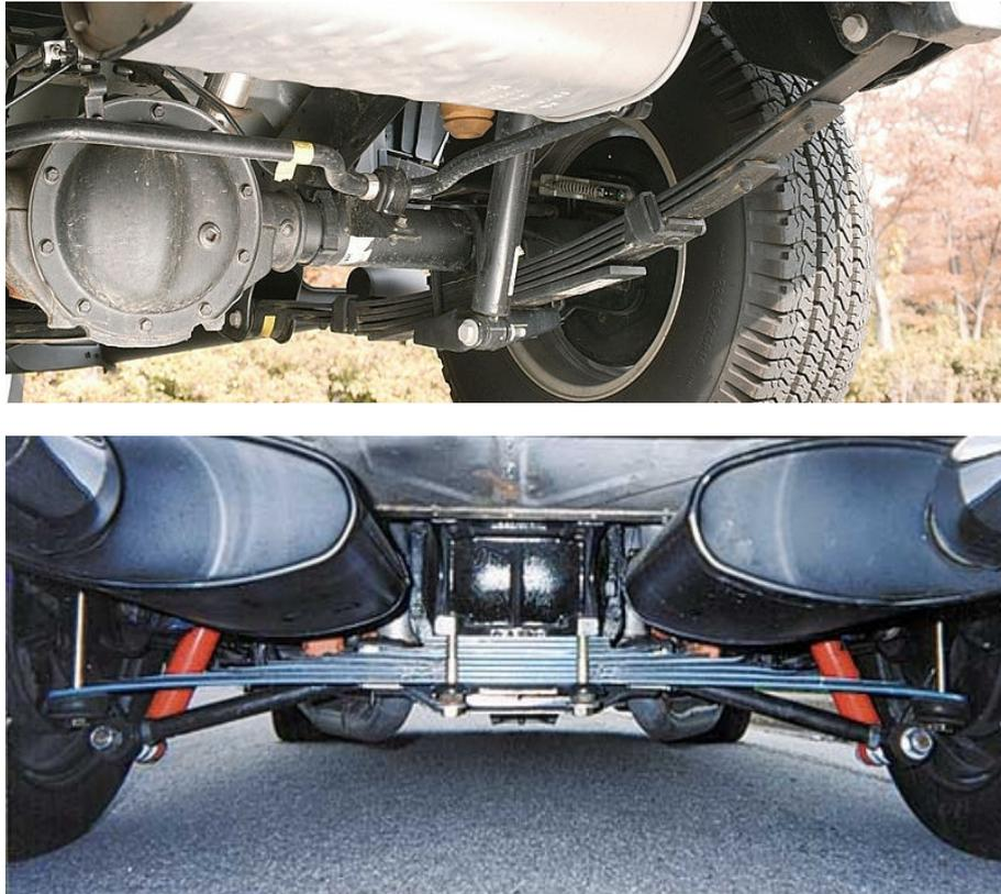
Figura 4. Feixe de molas instalado em pares longitudinais e em uma única transversal em relação ao comprimento do veículo (LATERAL-G, 2008).
