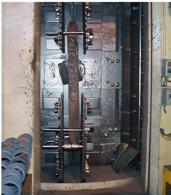
Figura 32. Câmara para aplicação do JCGST e esquema da aplicação da flexão e dos jatos de granalha pelas duas turbinas em paralelo.
