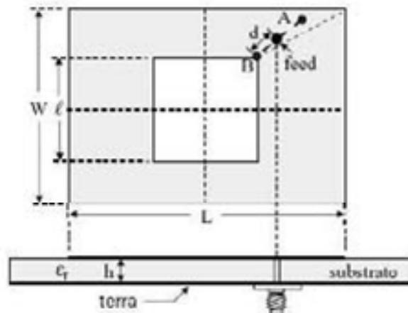
Figura 5.8: Antena retangular com fenda quadrada.
