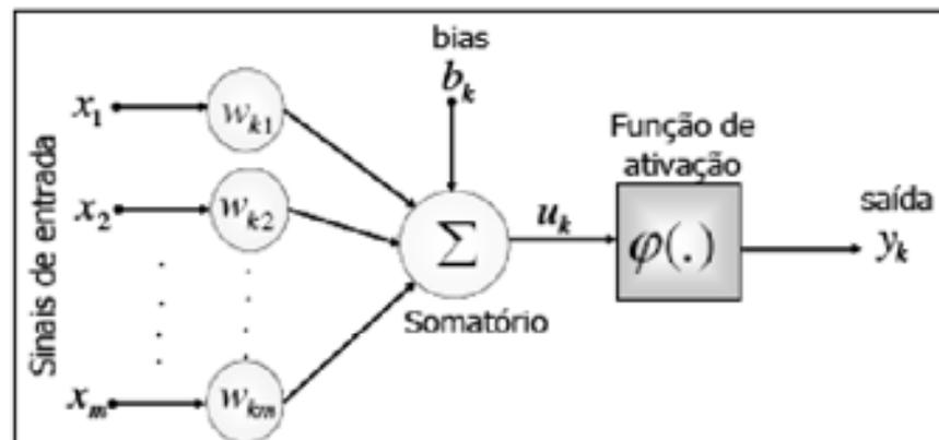
Figura 4.1: Ilustração da estrutura de um neurônio artificial.
