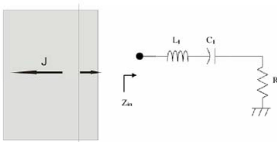
Figura 5.2: Circuito equivalente para um *patch* retangular.
