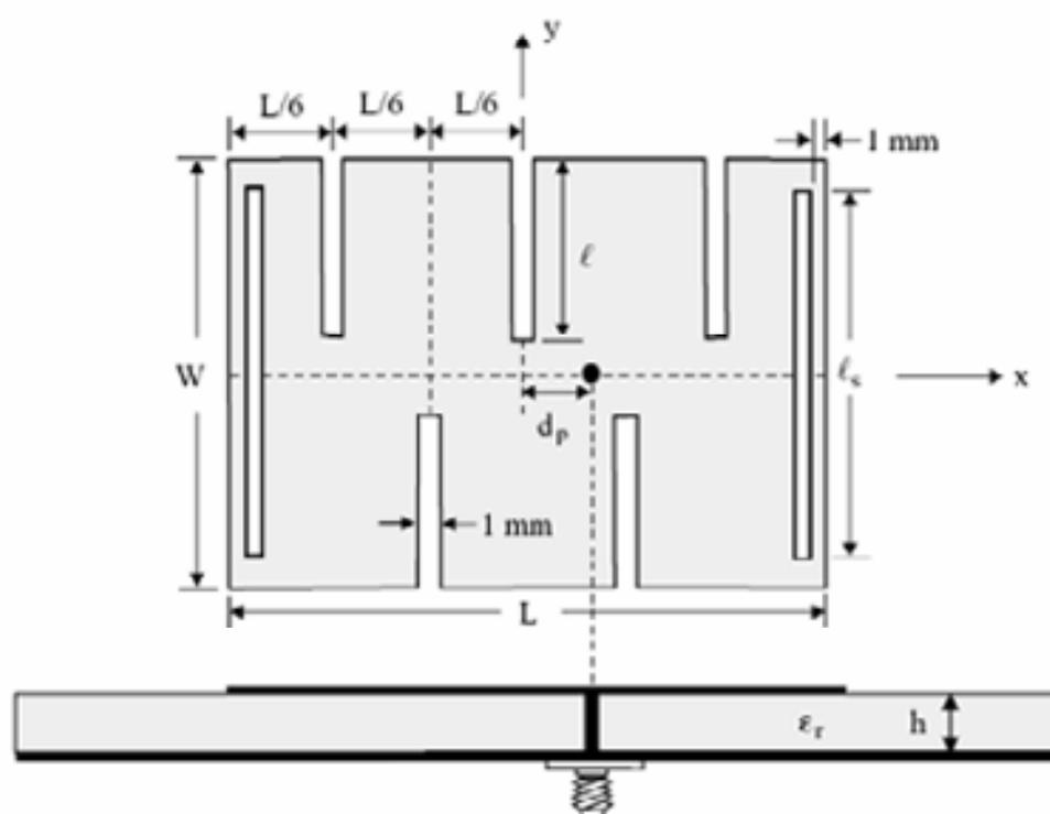
Figura 5.13: Antena retangular com sete fendas paralelas.
