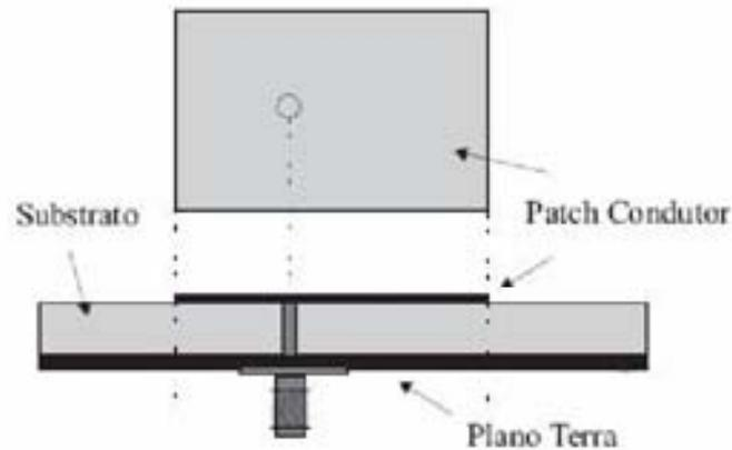
**Figura 2.1: Antena de microfita do tipo *patch*.**
