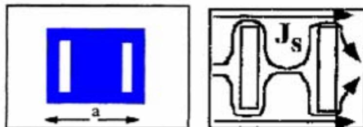
Figura 3.7: Efeito das fendas na antena de microfita.
