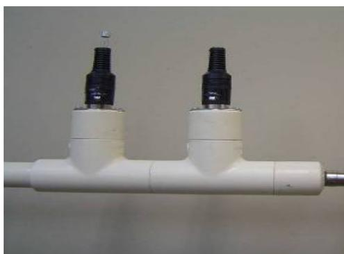
**Figura 6.3** – Sensores de temperatura e velocidade do ar.
