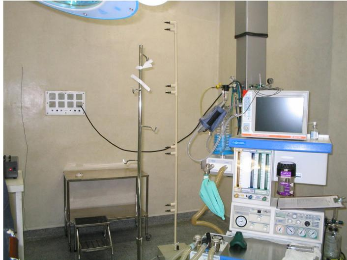
**Figura 6.6** – Foto do suporte para medição da velocidade e temperatura do ar.
