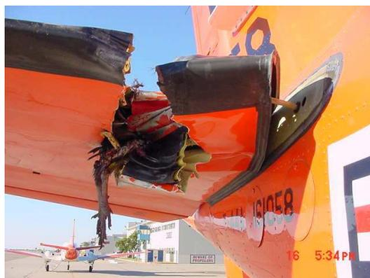
Figura 1.4: Dano causado pelo impacto de um pássaro (ALVES; CHAVES; BIRCH, 2003).
