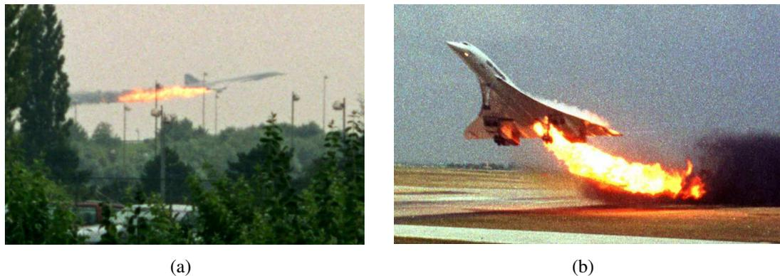
Figura 1.2: Incêndio no Concorde F-BTSC durante a decolagem devido ao impacto de fragmentos existentes na pista de decolagem (ROXBURGH, 2003).
