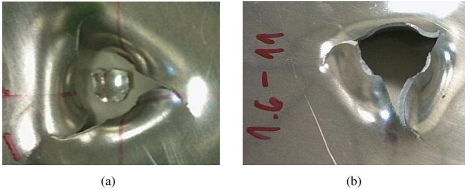
Figura 6.14: Detalhe da formação do tampão no material M1 a 127,5m/s com perfuração total, (a) vista anterior e (b) posterior.
