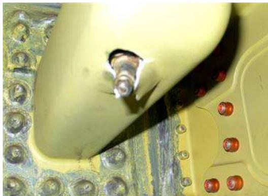
Figura 1.3: Tanque de combustível da asa direita do boeing 737-800 perfurado por parafuso (MSNBC - Associated Press, 2007).
