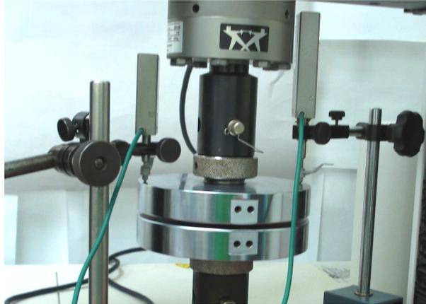
Figura 3.14: Método de medição do histórico de deslocamento no teste de compressão.
