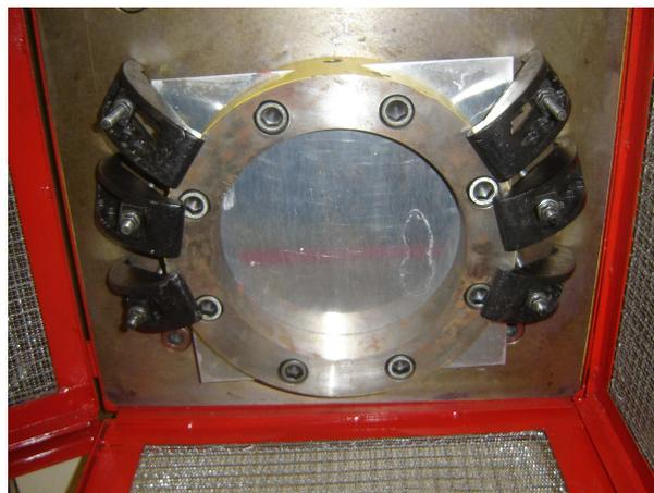
Figura 6.9: Arranjo para fixação das chapas alvo.
