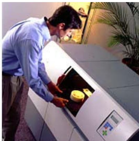
Figura 411 – Máquina MJM, – modelo: ThermoJet printer – Empresa: 3D SYSTEMS
