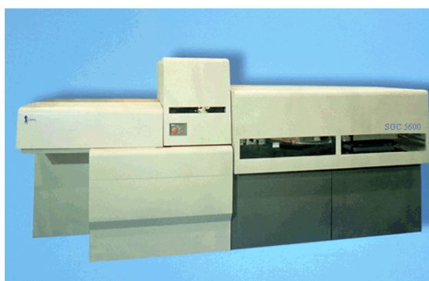
Figura 32 – Máquina de SGC, modelo: SGC 5600 – Empresa: Cubital
