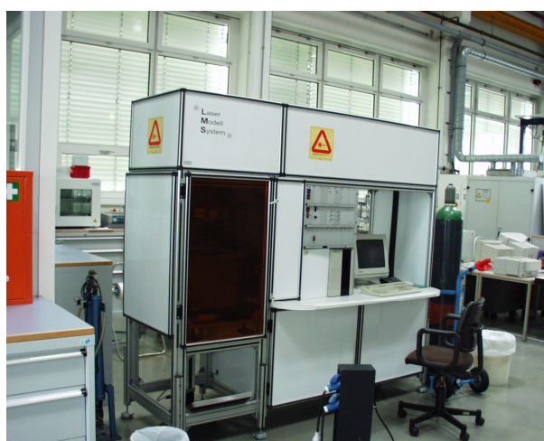
Figura 30 – Máquina de stereolithography, Instituto Fraunhofer para Automação – Empresa: Fockele & Schwarze
