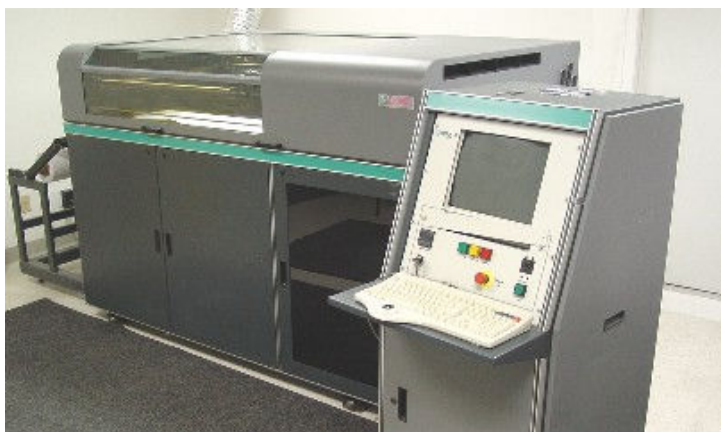
Figura 37 – Máquina de LOM, Modelo: HELISYS 2030 – Empresa: HELISYS
