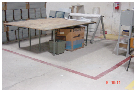
Figura 4.89 - Área de estoque de produtos feitos sob encomenda delimitada pela linha no chão em vermelho.
