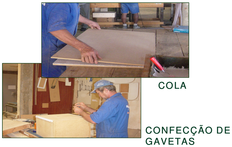
Figura 4.99 - Etapas de cola e confecção das gavetas na Fabricação do Protótipo
