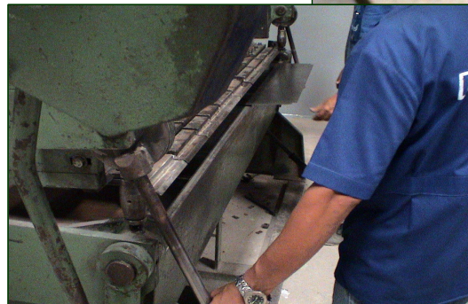
Figura 4.108 - Peça virada e dobra na etapa de fabricação do protótipo
