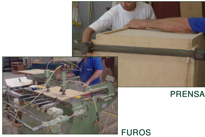
Figura 4.98 - Etapas de prensa e furos Fabricação do Protótipo
