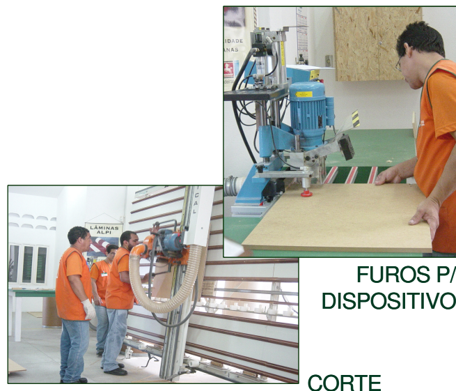
Figura 4.97 - Etapas de furos e corte na Fabricação do Protótipo
