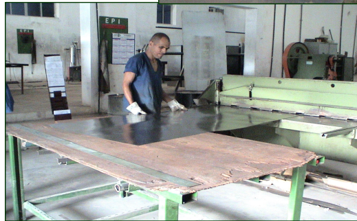
Figura 4.107 - Etapas de risco e corte na fabricação do protótipo
