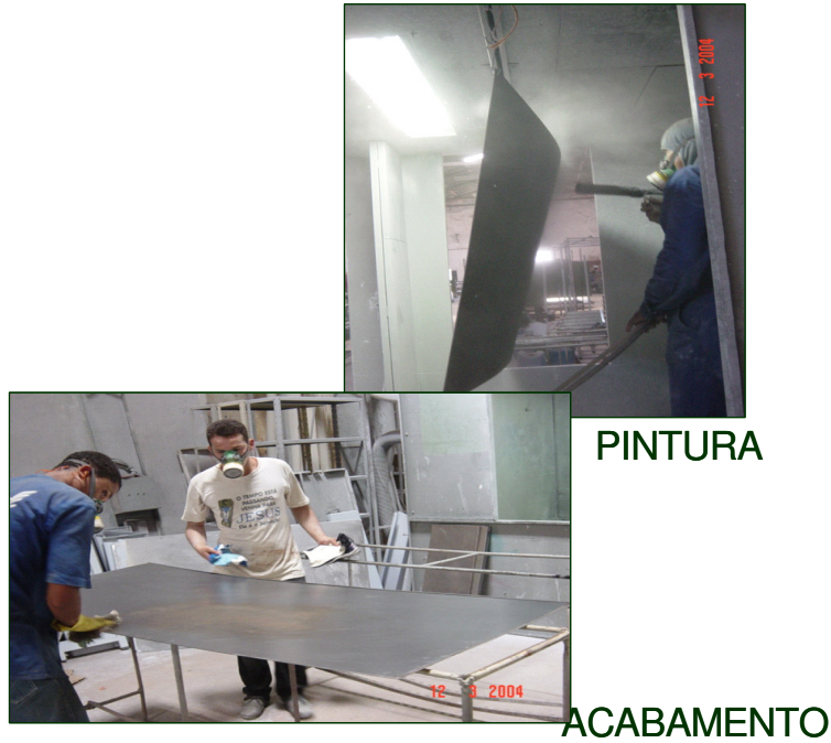
Figura 4.109 - Etapas de pintura e acabamento na fabricação do protótipo
