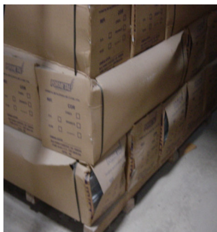
Figura 4.74 - Detalhe das bandejas danificadas devido ao excesso de peso ocasionado por mau condicionamento dos estoques
