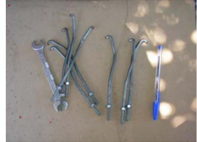
*Figura 14 – Detalhe dos parafusos de tensão. Foto Mario Maia, 2006.*
