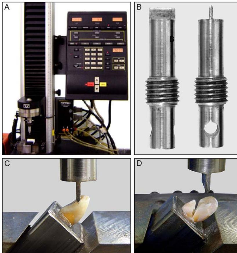
**Figura 5.** A) Máquina Universal de Ensaio INSTRON 4444 (INSTRON Corporation); B) Vista lateral e frontal da ponta; C) Ponta posicionada na face palatina do dente, utilizada para teste de fratura; D) Fratura do dente após o teste
