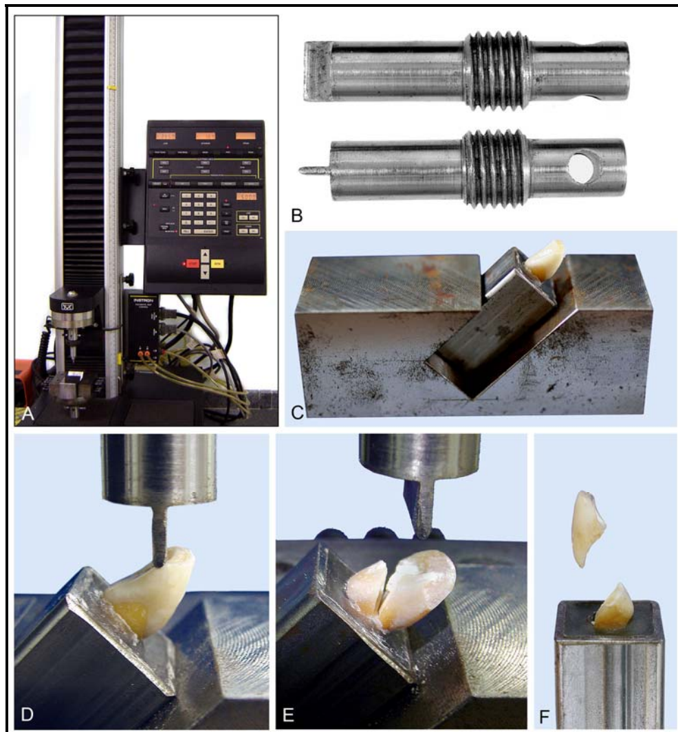
Figura 7: A - Máquina Universal de Ensaio Instron 4444 (Instron Corporation); B - Vista lateral e frontal da ponta; C - Corpo-de-prova posicionado no dispositivo com angulação de 45° em relação ao plano horizontal; D - Corpo-de-prova e ponta em posição na máquina; E - Momento da fratura coronária e F - Fragmentos coronários após teste de compressão.
