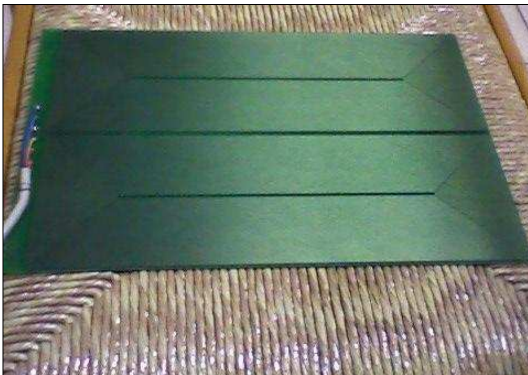
Figura 52: Conjunto de bobinas construído em circuito impresso.
