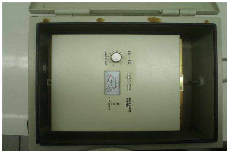
Figura 22: Potenciômetros de ajuste da sensibilidade.
