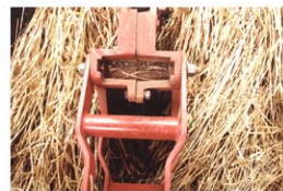
Figura 12 - Detalhe do mecanismo de semeadura de uma linha de soja.
