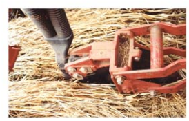
Figura 13 - Detalhe da lateral do mecanismo de semeadura de uma linha de soja.
