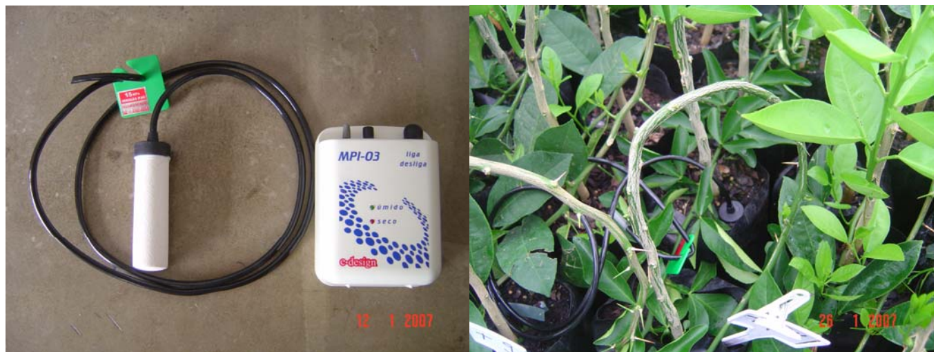
Figura 2 – Sensor Irrigás ® empregado para monitoramento de potencial hídrico do substrato por tensiometria (esquerda). Instalação do sensor em sacola de muda cítrica (direita). Araras, 2007
