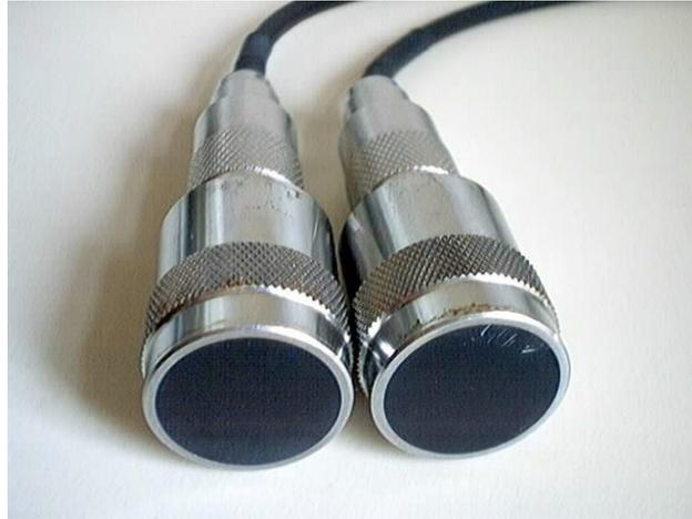
Figura 53 – Transdutores de ultra-som da marca Panametrics, modelos V318, utilizados nos testes do sistema.
