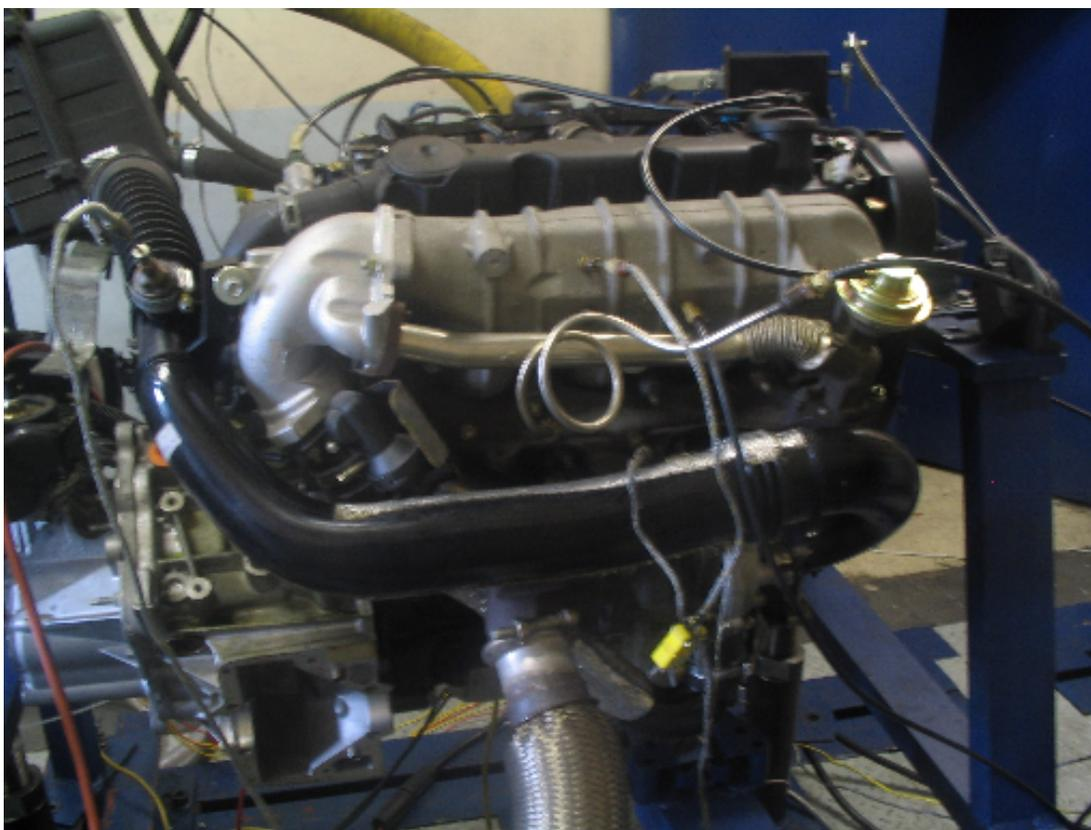
**Figura 46** : Motor Peugeot utilizado no ensaio fase-período.
