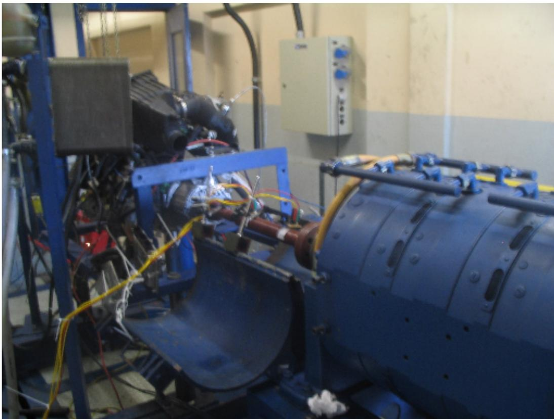
**Figura 49:** Banco de motores, onde pode ser visto o motor, o eixo cardã (instrumentado) e à direita o dinamômetro.
