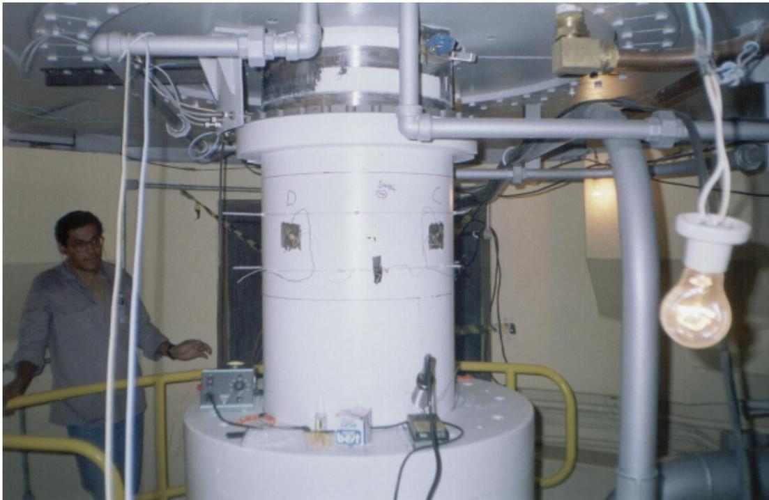
**Figura 41:** Fotografia mostrando a soldagem dos extensômetros e a montagem da ponte de Wheatstone.
