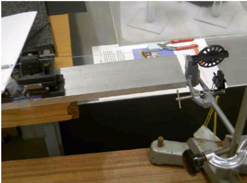
Figura 4.27 - Sistema mecânico para a análise de deformações longitudinais em relação às forças aplicadas nas FBG em fibras HiBi.
