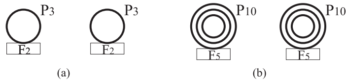
Figura 4.5: Exemplos de lugares de fusão numa RPHD: (a) discretos e (b) diferenciais.
