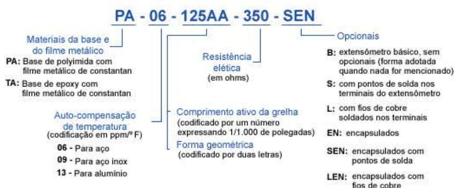
Figura A.11: Sistema de codificação (EXESENSOR, 2007).
