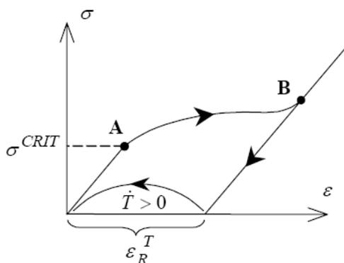
Figura 2.5: Comportamento tensão-deformação-temperatura do EMF simples.
