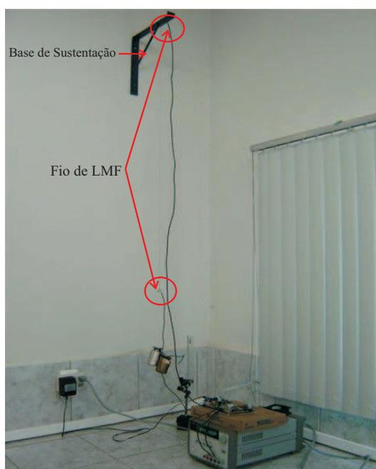
Figura 4.1: Foto da plataforma utilizada para treinamento termomecânico dos fios de LMF.
