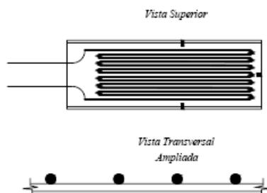
Figura A.2: ERE do tipo fio (ANDOLFATO; CAMACHO; BRITO, 2004).
