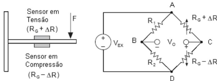
Figura A.28: Diagrama elétrico da ponte de Wheatstone com dois extensômetros.
