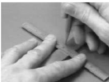
Figura A.14: Marcações do posicionamento do extensômetro.
