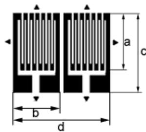
Figura A.7: Extensômetro uniaxial duplo (ECXELESENSOR, 2007).
