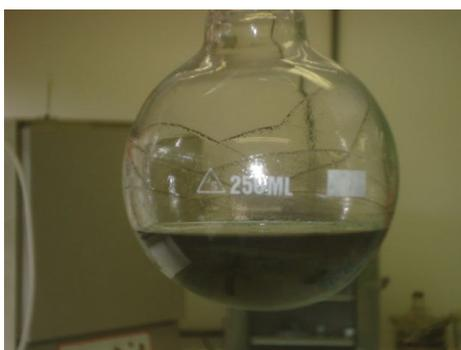
Figura 22. Solução resultante após a primeira etapa de digestão ácida em solução de HCl 1:1.
