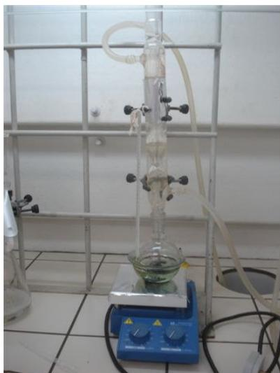
Figura 21. Montagem utilizada nas etapas de digestão ácida em solução de HCl 1:1.
