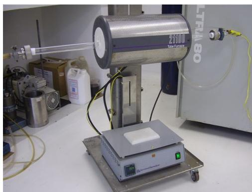
Figura 23. Sistema utilizado no tratamento térmico (recozimento) em atmosfera de argônio puro a 800°C por 2 h.
