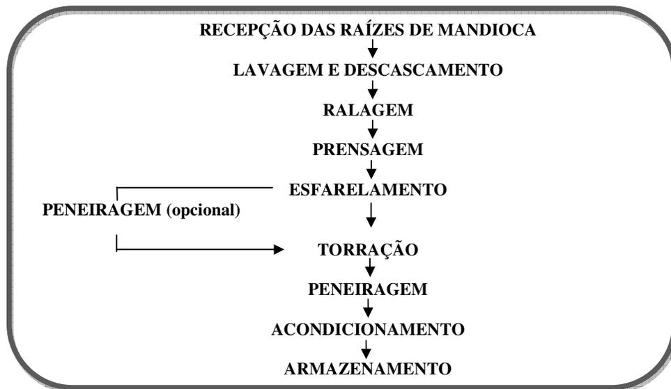
**Figura 2.** Fluxograma do processamento de farinha de mandioca.
