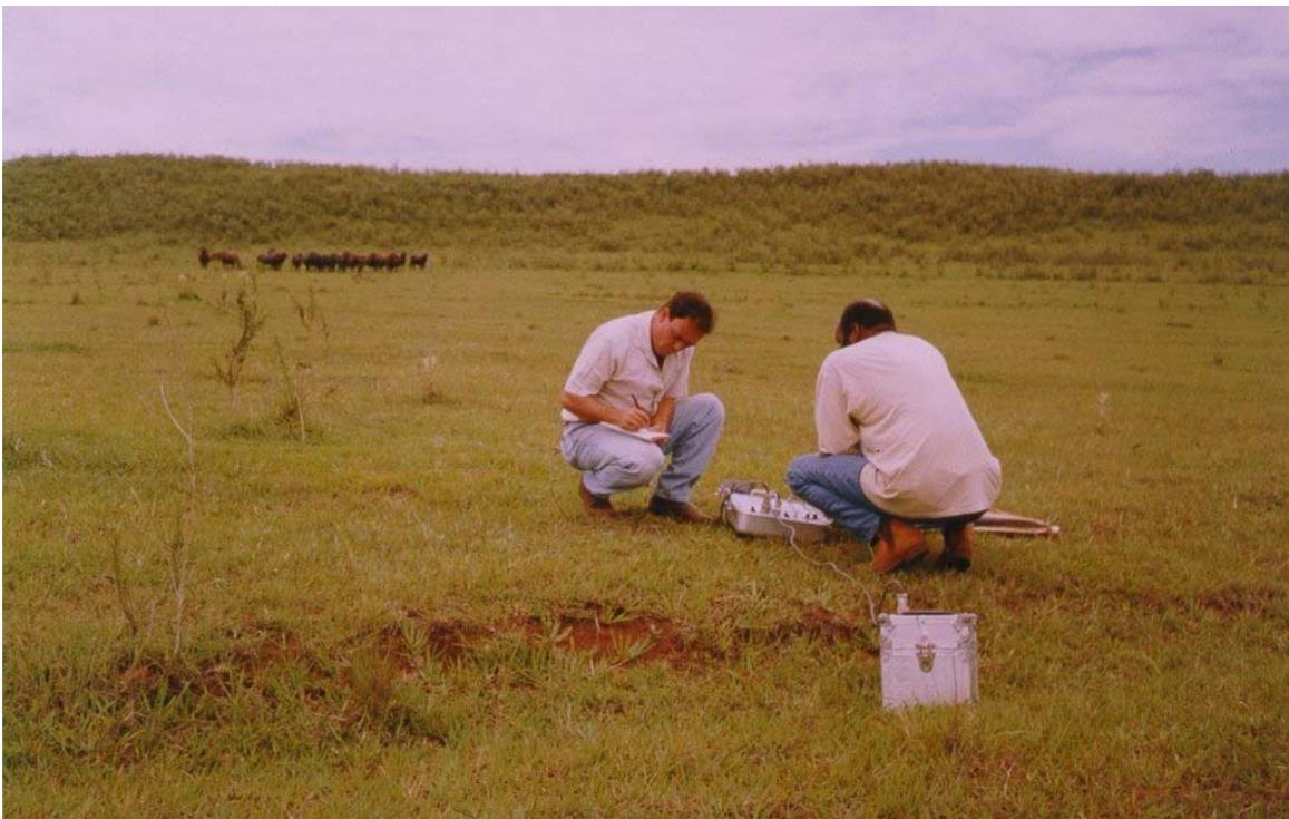
Figura 4.7. Adquirindo dados – Sirotem MK3.
