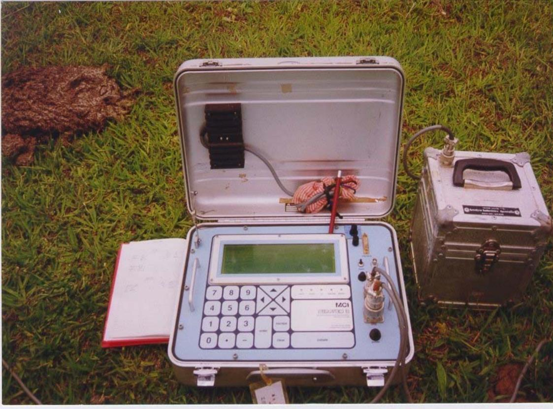
Figura 4.6. Console do Sirotem MK3.
