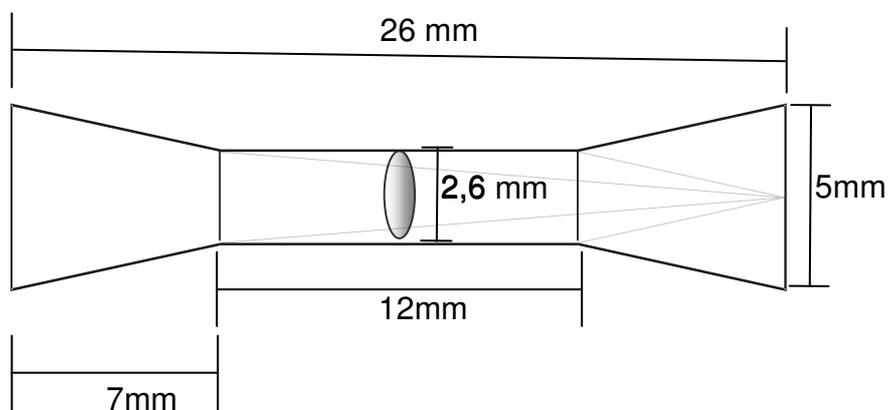
Figura 2 - Desenho esquemático do corpo-de-prova com respectivas medidas
