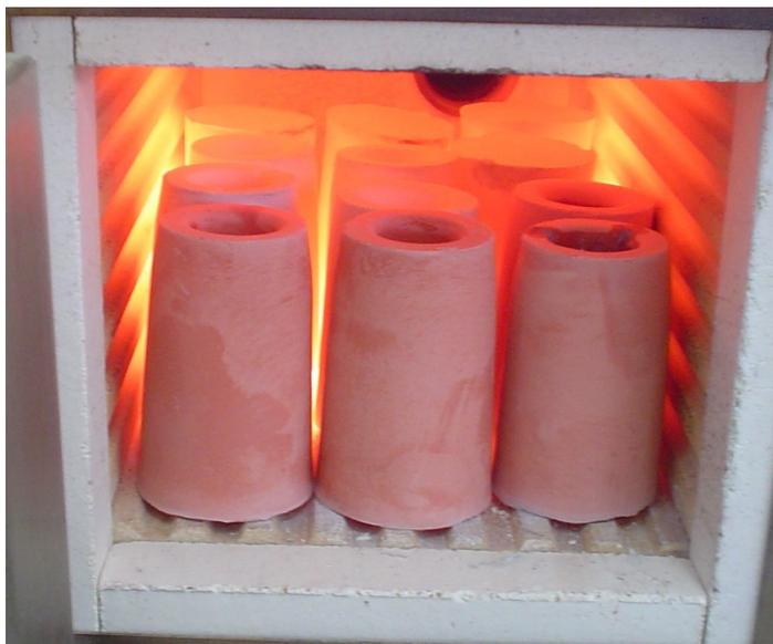
Figura 5 – Aneis posicionados para desidratação e expansão
