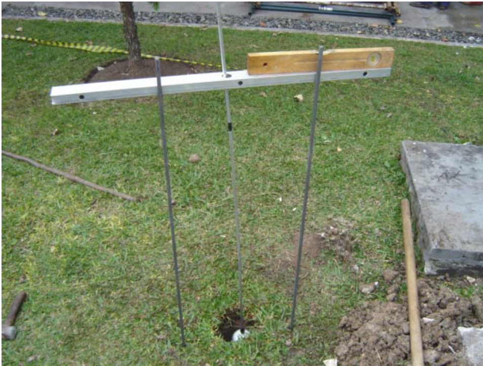
FIGURA 12: DETALHE DO EQUIPAMENTO MONTADO PARA A MEDIÇÃO DO REBAIXO D'ÁGUA COM A UTILIZAÇÃO DA HASTE COM A BÓIA
