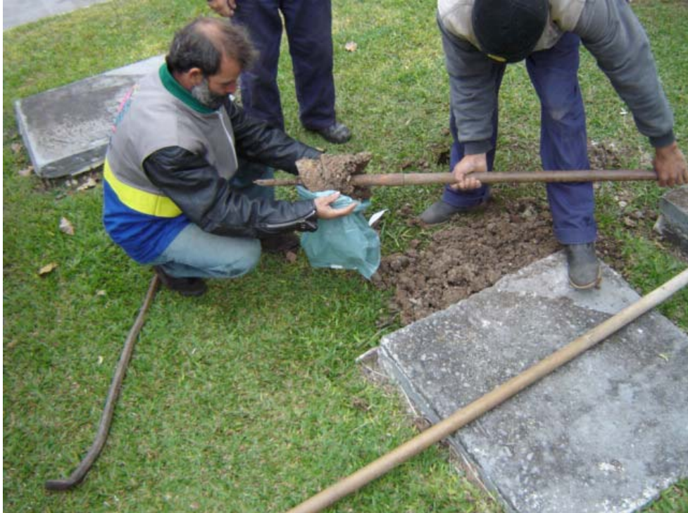
FIGURA 16 - DETALHE DA COLETA DE AMOSTRA DE SOLO PARA POSTERIOR ENSAIO EM LABORATÓRIO.
