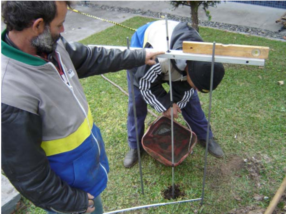
FIGURA 13 - DETALHE DO ENCHIMENTO DA COVA CILÍNDRICA
