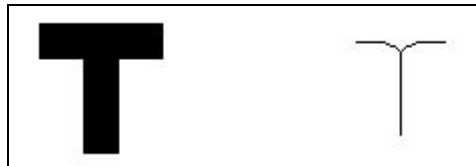
Figura 3.8: Exemplo do afinamento de bordas utilizando o algoritmo de Stentiford [Fonte: (FACON, 2005)].
