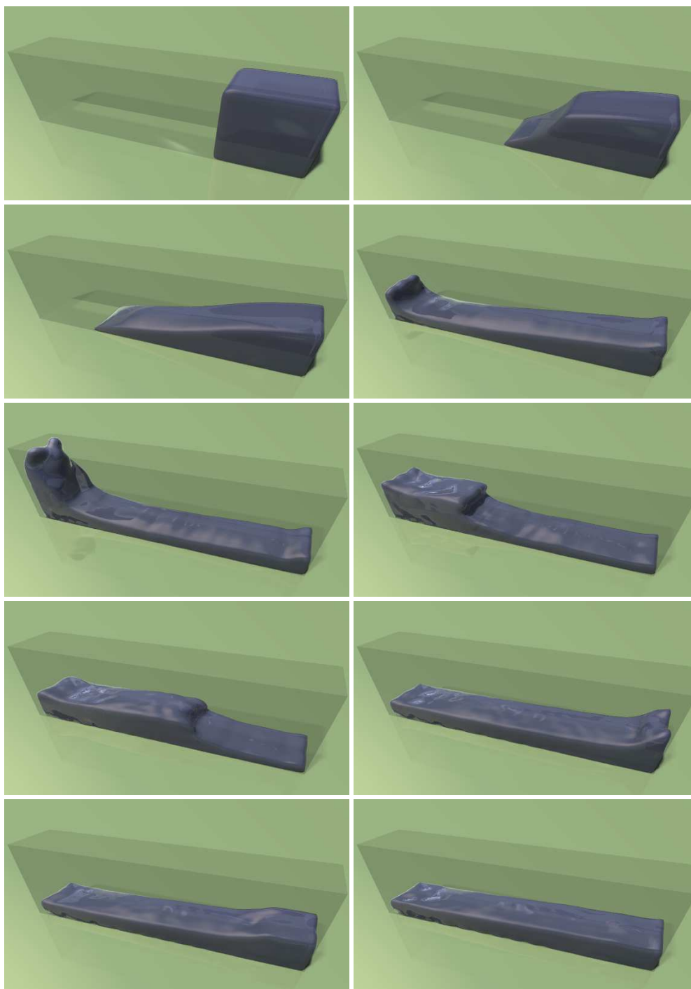
Figura 5.11: Simulação SPH da quebra de uma barragem utilizando 10^4 partículas.
