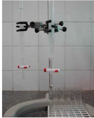
Figura 26: Separação das frações de nanocápsulas contendo fármaco encapsulado e fármaco livre através da coluna de vidro com Sephadex G50®.
