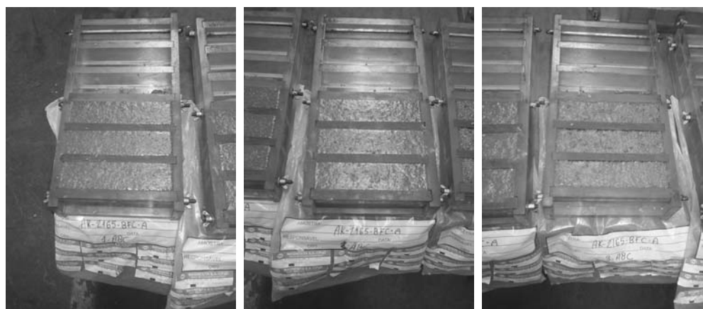
Figura 4.1.4: Cura dos cp's: 1A, 1B e 1C (esquerda); 2A, 2B e 2C (centro); 3A, 3B e 3C (direita).
