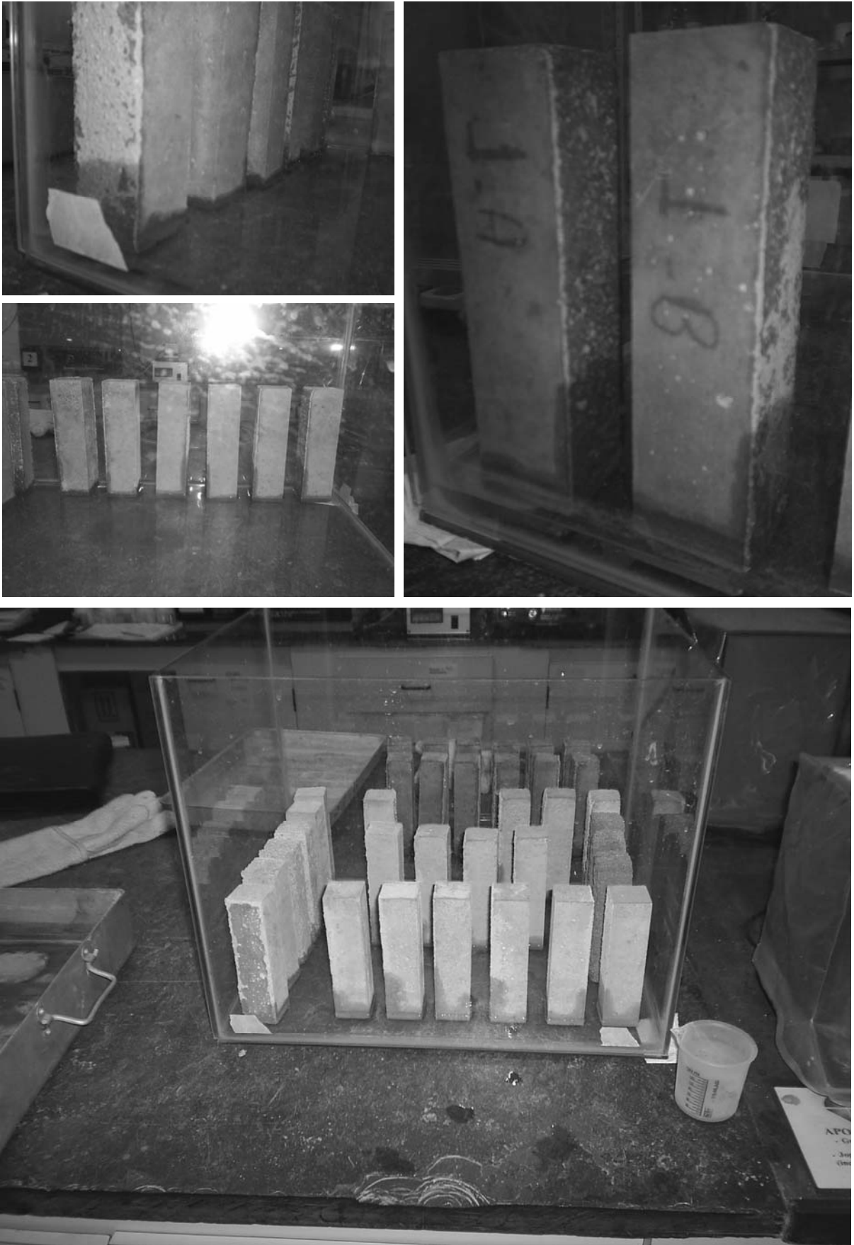
Figura 5.3.7: Propagação capilar nas superfícies não conformadas (III).
