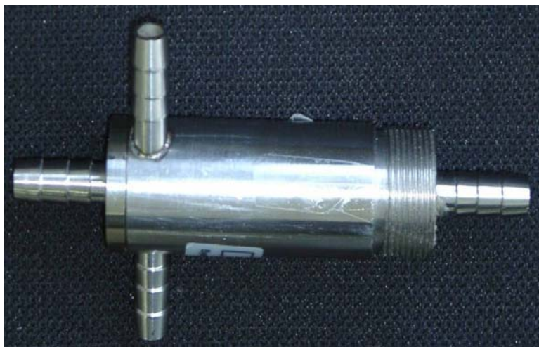
Figura 12- Foto do hidrociclone especialmente projetado para a separação de células animais.
